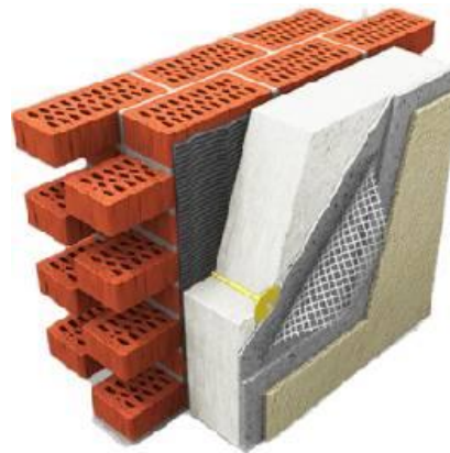
Рис. 3.21. Утеплення цегляних стін
