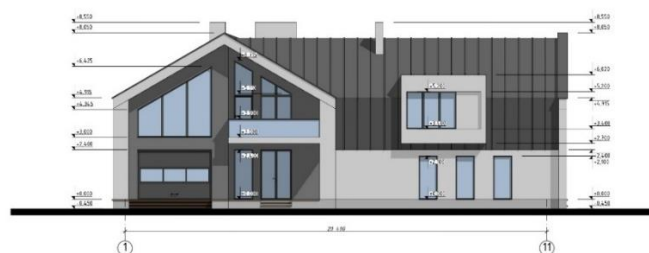
Рис. 3.11. Фасад в осях «1-11»
