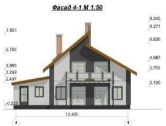
Рис. 65. Житловий будинок фермера. Фасад в осях 4-1.
