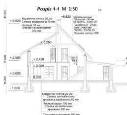
Рис. 69. Розріз житлового будинку фермера в осях 1-1.
