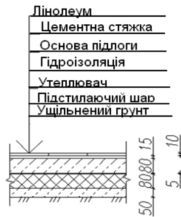
Рис. 1.6 Конструкція підлоги з лінолеуму
