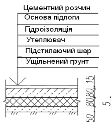
Рис. 1.7 Конструкція цементної підлоги
