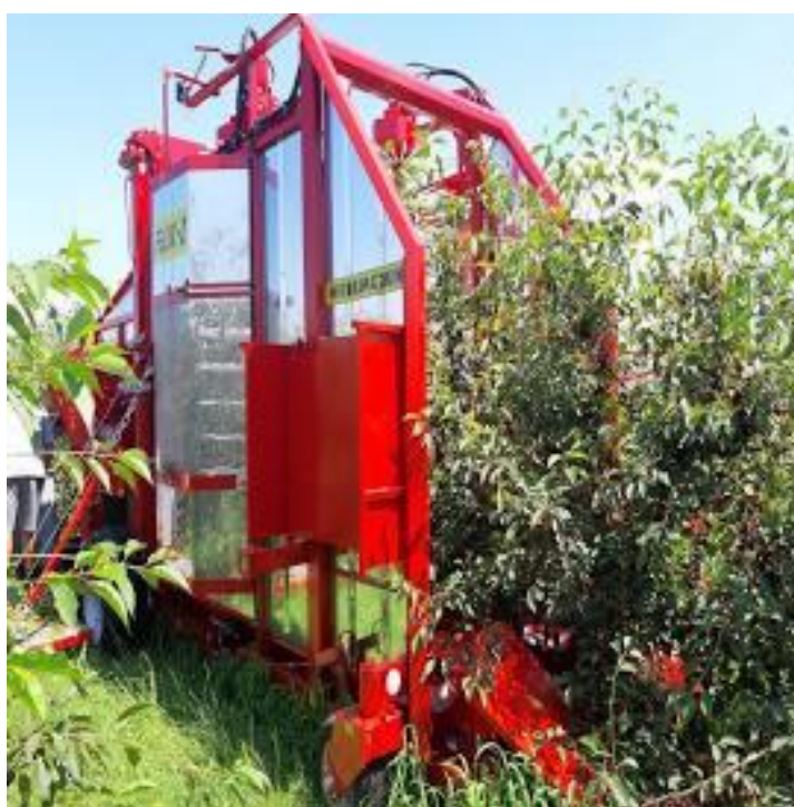
Рис. 3.4. Комбайн для збору вишень та слив FELIX/Z
