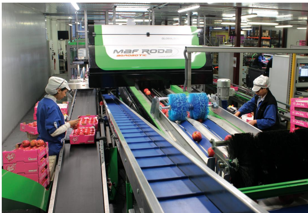
Рис. 3.13. Лінія товарної обробки яблук MAF RODA (Франція) (джерело: https://www.maf-roda.com/en/page/novacoop-automatic-robot-packing-line.php )
