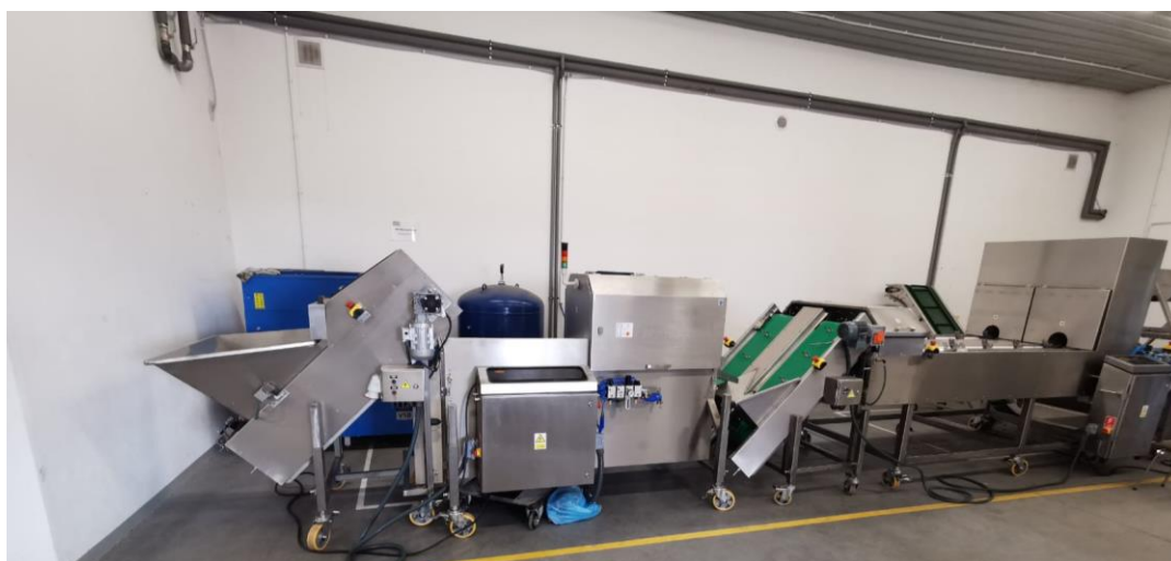
Рис. 3.25. Механізований пункт із післязбиральної доробки цибулі (джерело: https://prom.ua/ua/p464033156-sortirovochnyj-stol-dlya.html )
