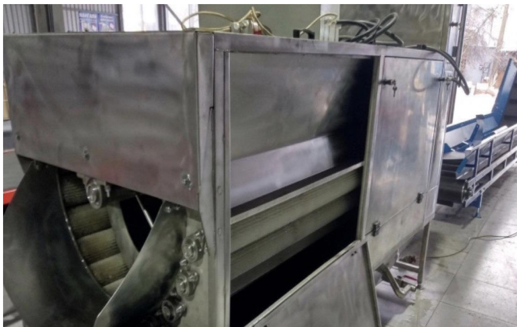
Рис. 3.22. Барабанно-щіткова мийка для коренеплодів (джерело: https://prom.ua/ua/p1391556863-mojka-dlya-korneplodov.html )
