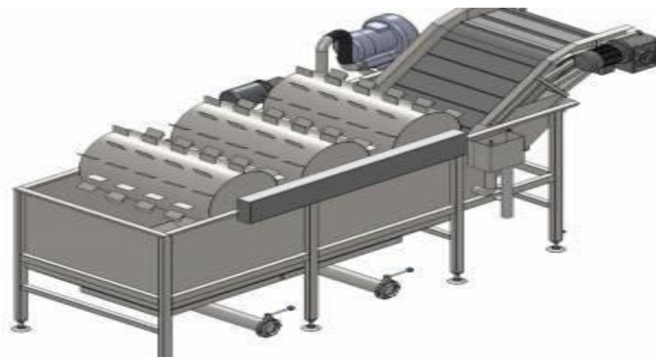
Рис. 3.23. Мийна машина для невеликих партій коренеплідних овочевих культур ПрАТ «Каховський експериментальний механічний завод»
