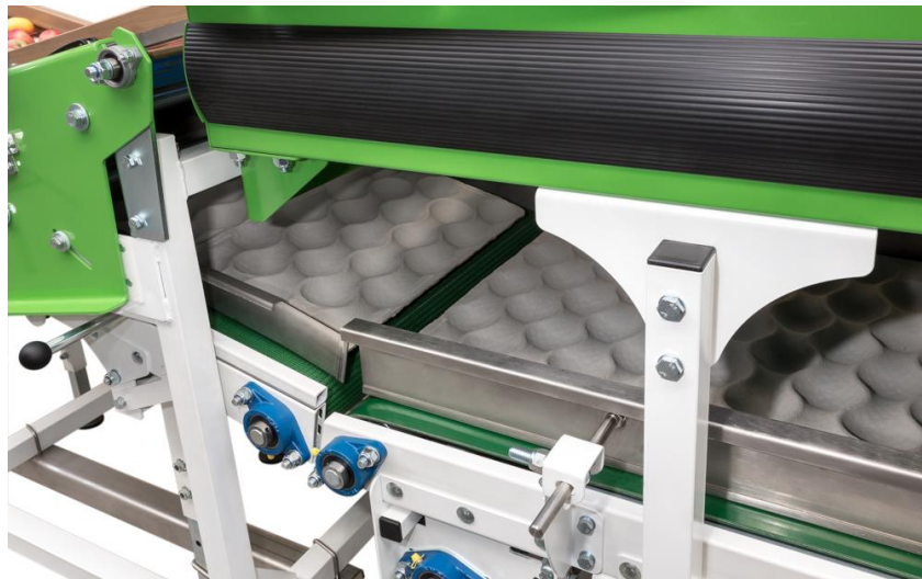
Рис. 3.12 (а, б, в, д) Автоматична лінія для пакування фруктів на підкладку (альвеоли) (джерело: https://www.sorter.pl/pl )
