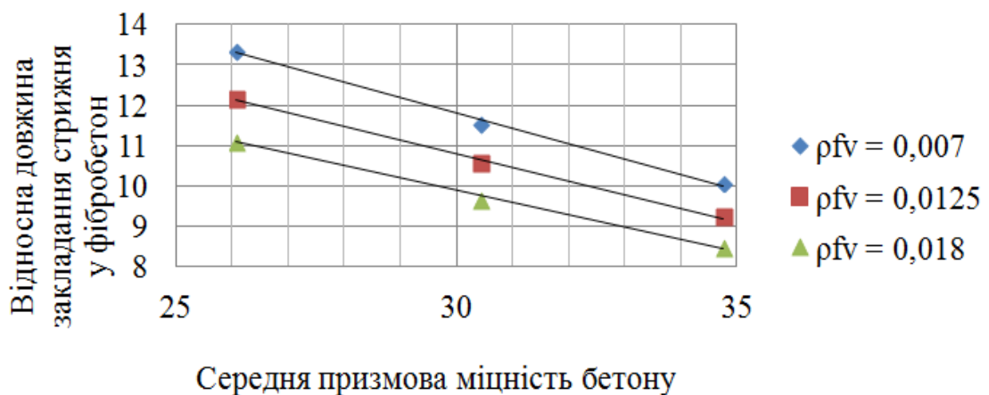
Рис. 3.13 – Залежність \langle \frac{l_b}{\varnothing} - f_{cm,prism} \rangle при \sigma_S = 500 МПа в кінці зсуву незавантажених кінців стрижнів діаметром 10 мм
