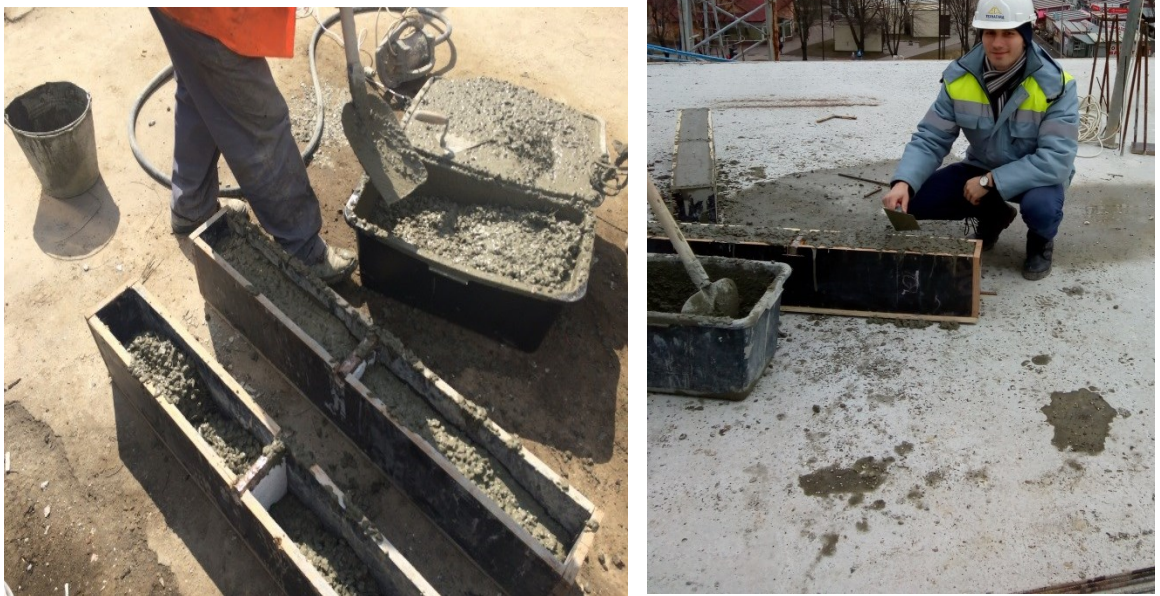
Рис. 2.8 – Виготовлення балкових зразків
