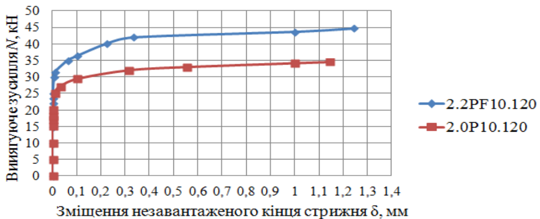
Рис. 3.8 – Залежність зміщення незавантаженого кінця стрижня від витягуючого зусилля для призматичних зразків 2.2PF10.120, 2.0P10.120
