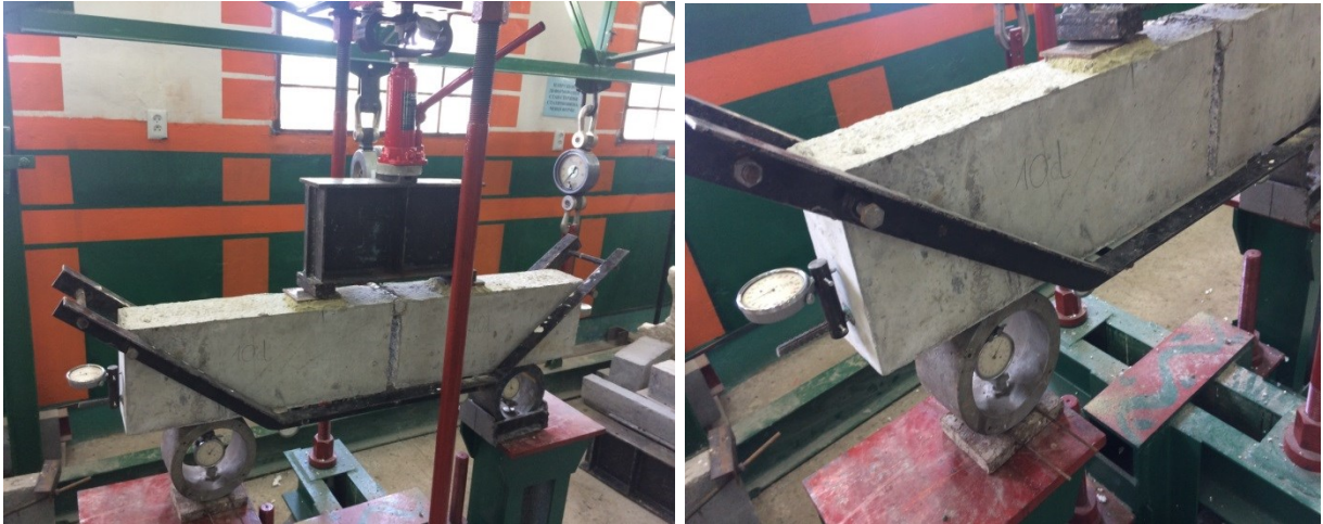
Рис. 2.16 – Загальний вигляд робочого стенда при випробуванні балочних зразків
