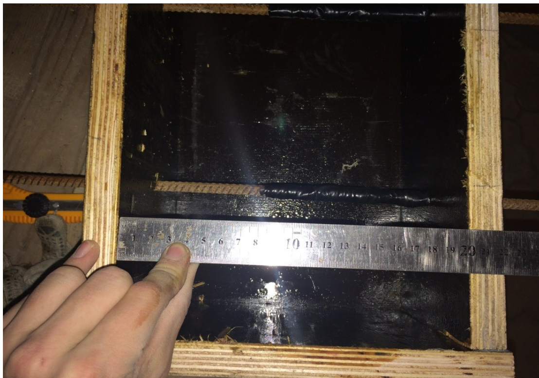
Рис. 2.3 – Підготовка форми для призмових зразків
