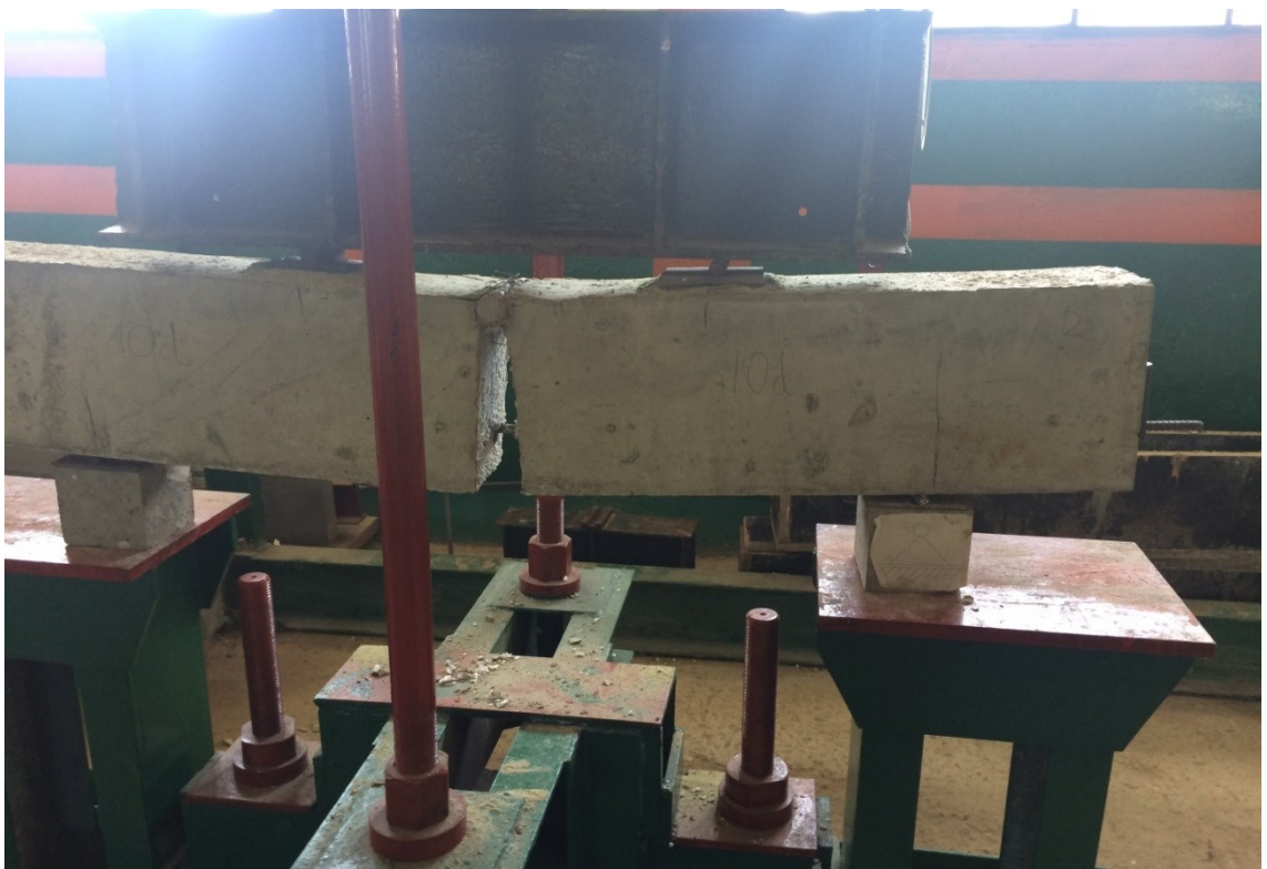
Рис. 2.18 – Вигляд дослідної балки при дії руйнівного навантаження
