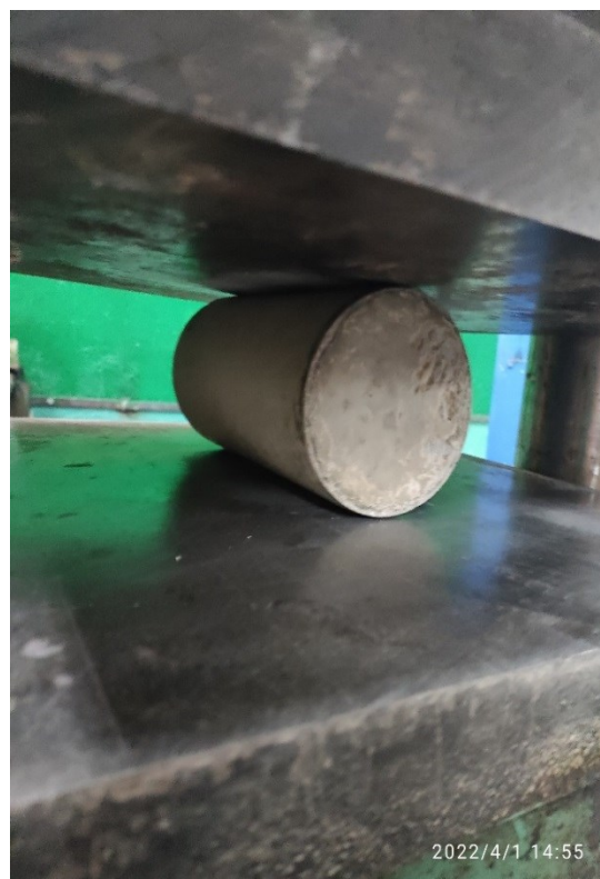
Рис. 2.1 – Випробування контрольних зразків на механічні характеристики: а – призм на стиск; б – циліндрів на стиск; в – циліндрів на розтяг за розколювання.
