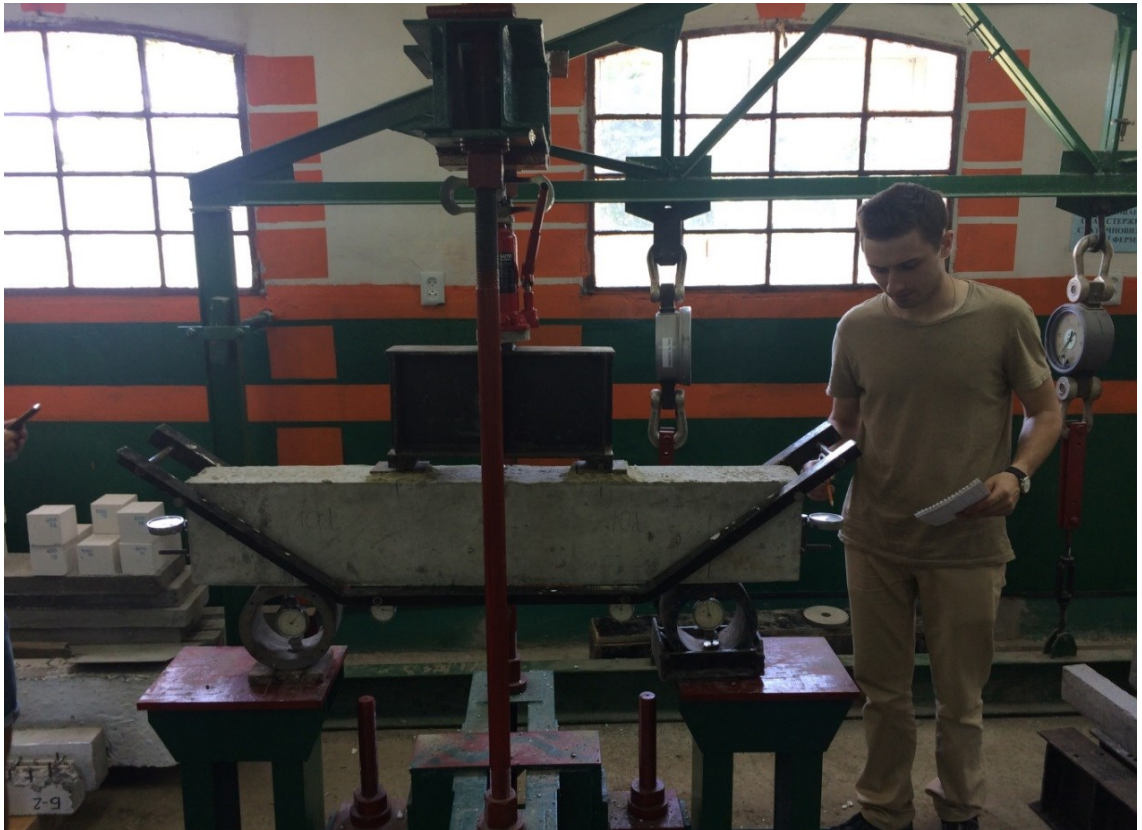
Рис. 2.17 – Зняття показів на дослідному зразку
