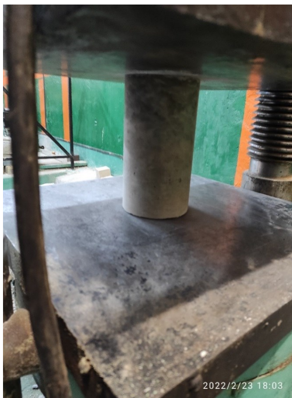
Рис. 2.1 – Випробування контрольних зразків на механічні характеристики: а – призм на стиск; б – циліндрів на стиск; в – циліндрів на розтяг за розколювання.
