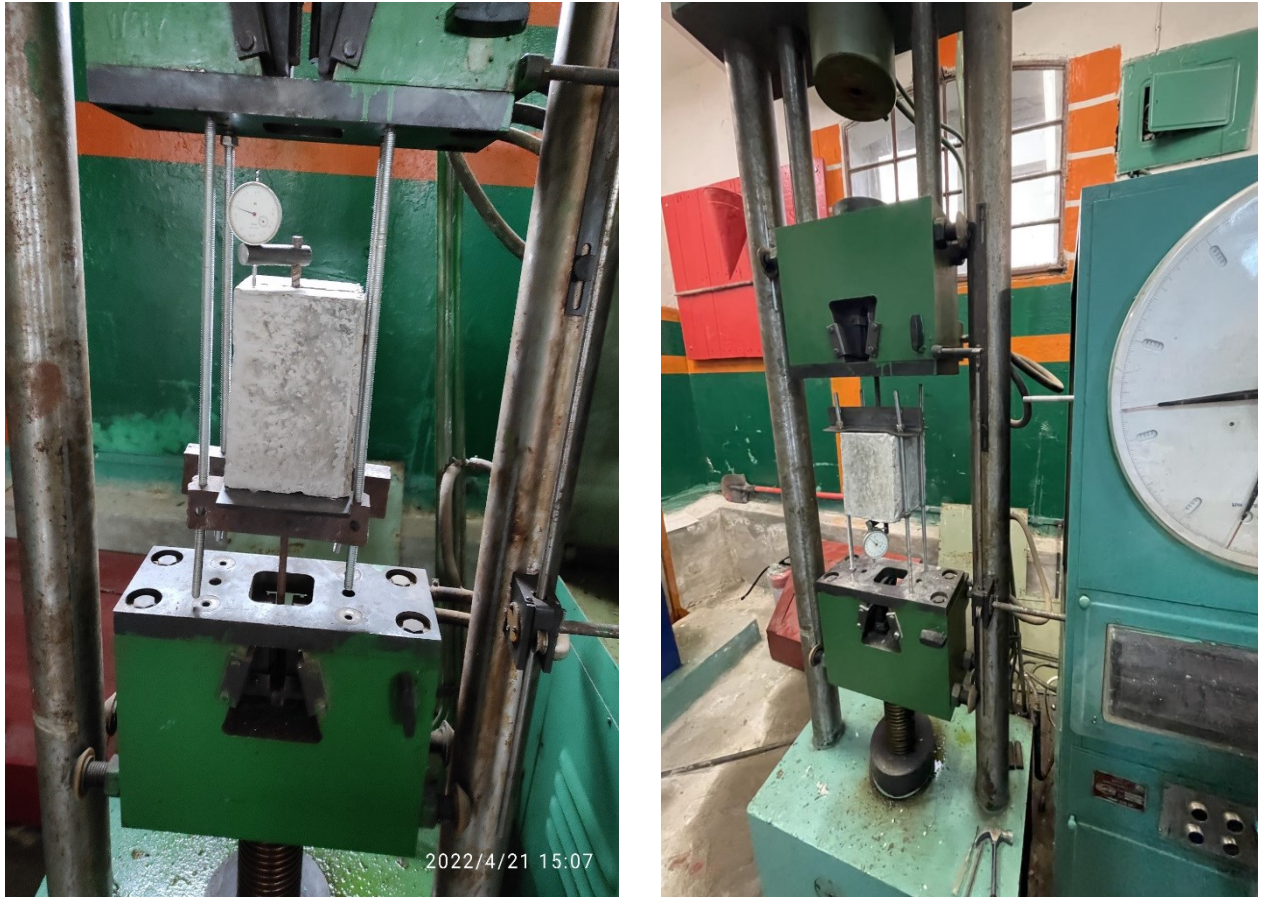
Рис. 2.10 - Випробування призмових зразків
