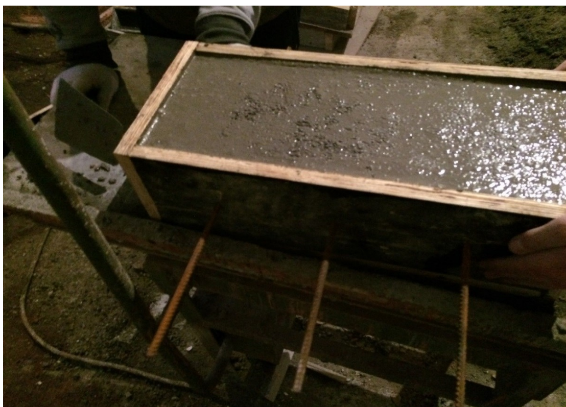
Рис. 2.4 – Виготовлення призмових зразків
