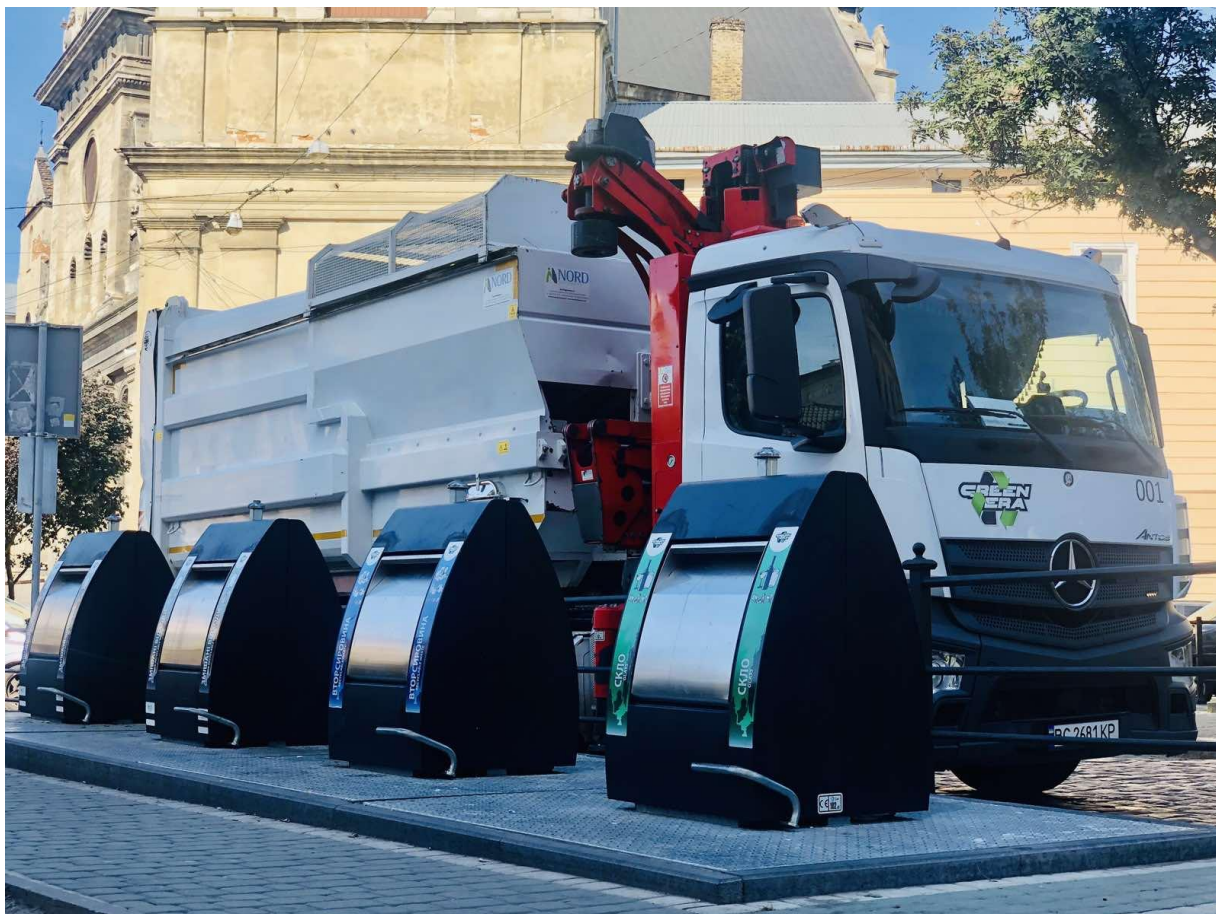
Рисунок 3.2 – Підземні системи зі зовнішнім підйомним пристроєм
