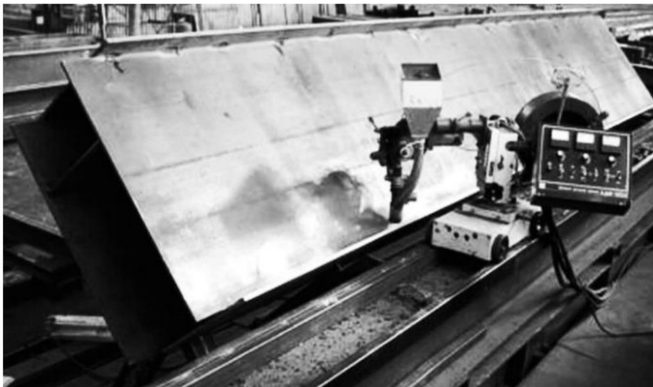
Рисунок 1.5 – Зварювання «в човник» поясних швів коробчастої балки
