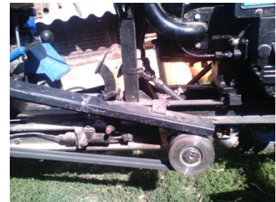
Рис. Схема та загальний вигляд трансмісії мінітрактора:
