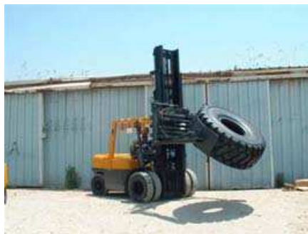
Рисунок 1.6 – Зовнішній вигляд колесознімача, встановленого на вилковий навантажувач
