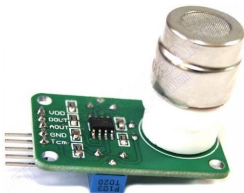
Рис. 2.7 - Сенсор MG811 та його схема підключення [13].
