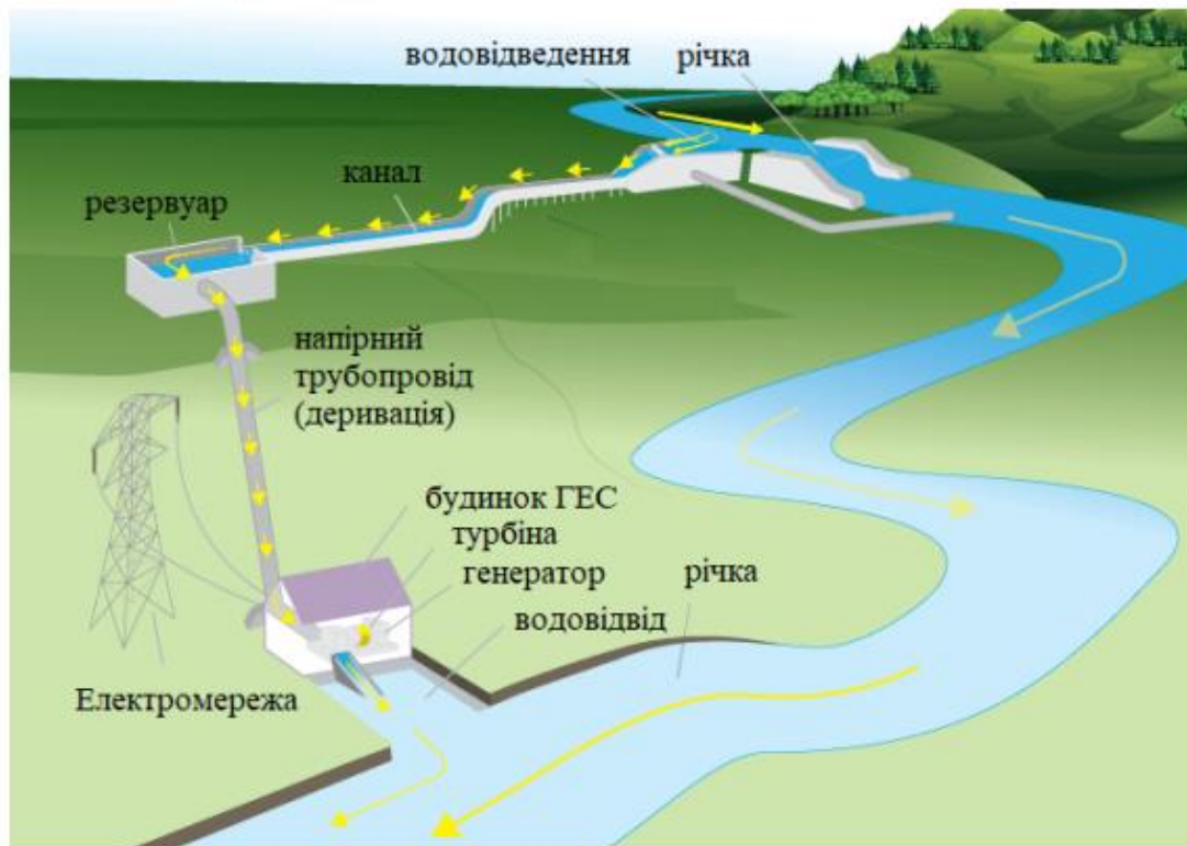
Рисунок 2.5 – Дериваційна схема створення напору
