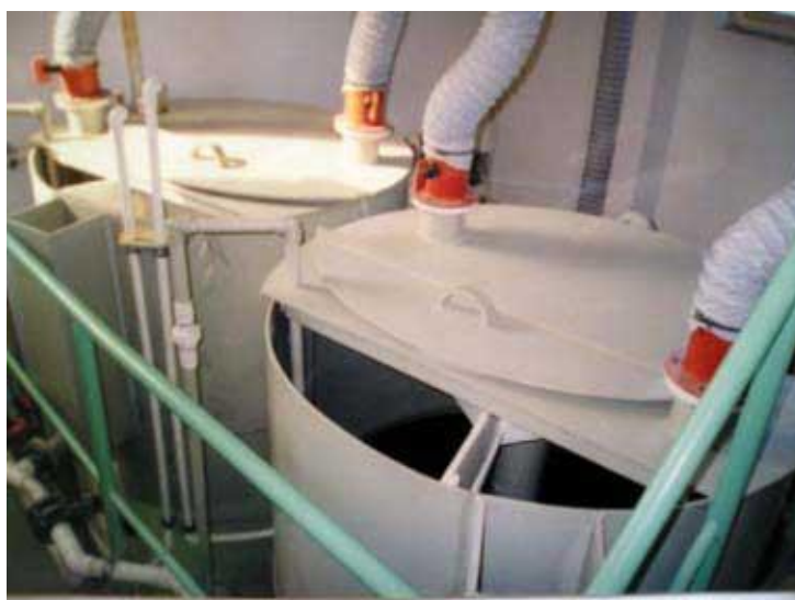
Рис. 2. Вертикальні відстійники із системою трубопроводів для відсмоктування газів, пари та подачі чистого повітря (власна розробка та фото)
