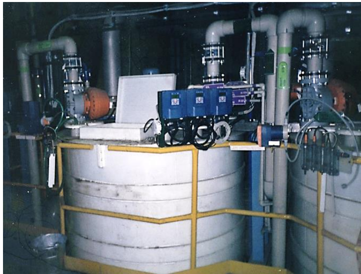
Рис. 1. Змішувач-реактор непроточного типу для ступінчастого дозування реагентів з датчиками контролю параметрів рН та Eh (власна розробка і фото)
