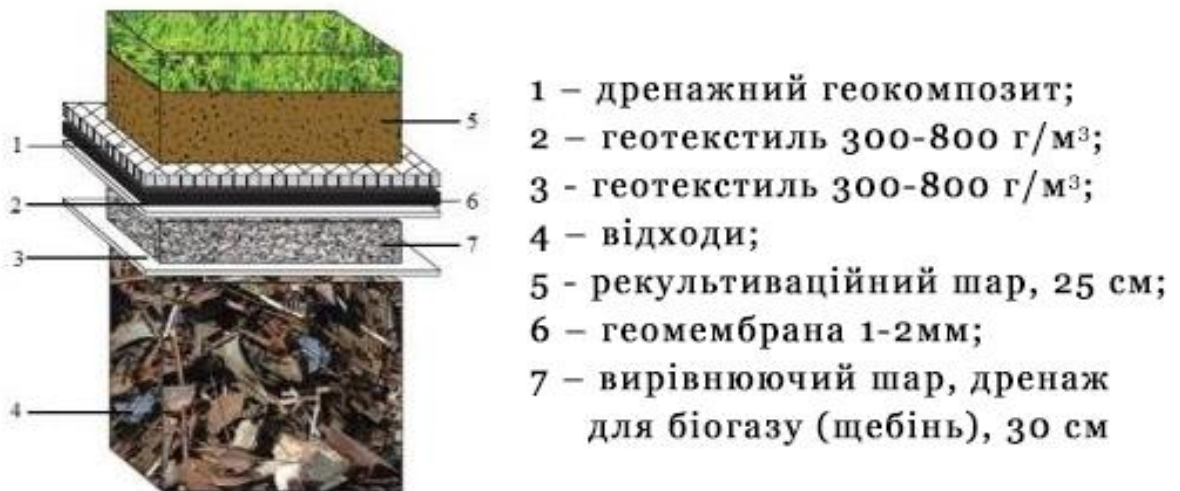
Рисунок 1.8 – Схема конструкції захисного екрану поверхні полігону
