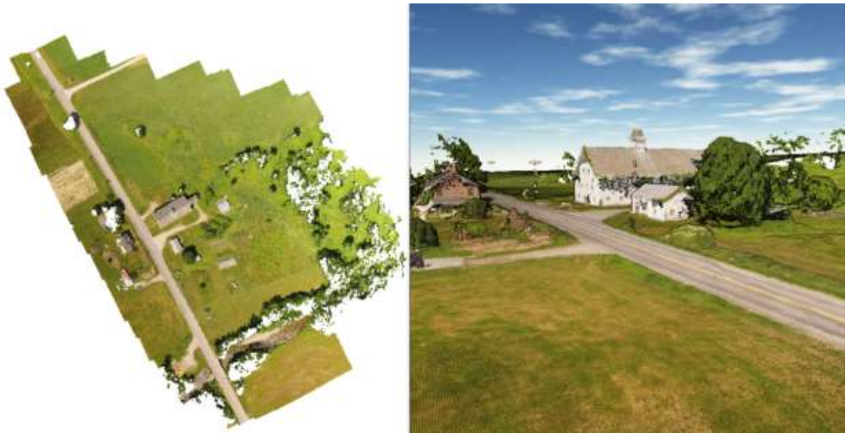
Рис.2.1. Візуалізація тривимірної хмари точок, згенеровану з пікселів у точки з можливістю експортувати в будь-який підтримуваний формат хмари точок
