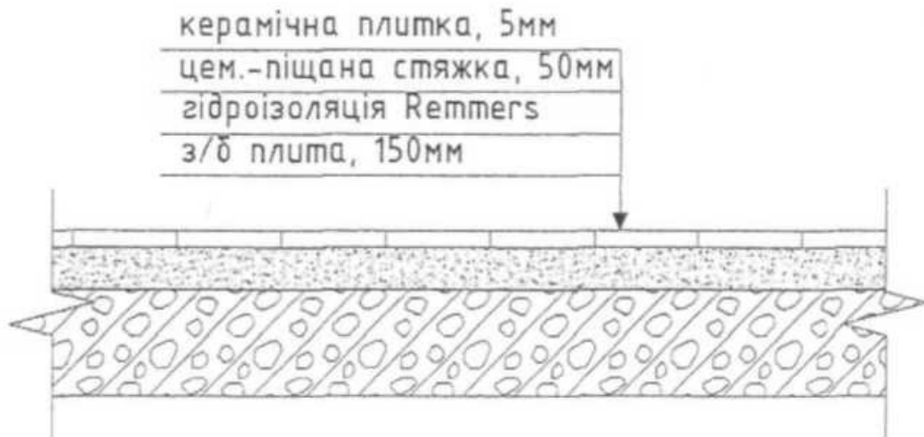
Рис.2.1. Схема конструкції перекриття
