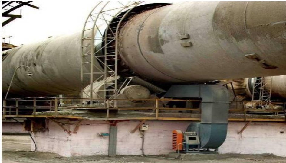
Рис. 4.8 – Фрагмент обертової печі виробництва портландцементного клінкеру
