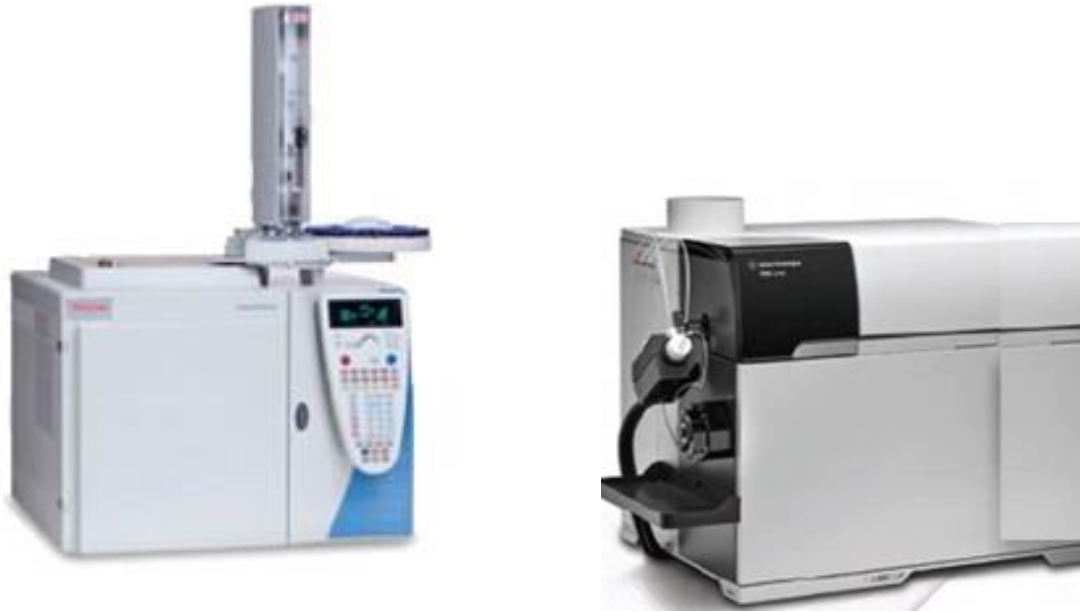
Рис. 3.1 - Газовий хроматограф з мас-селективним детектором
