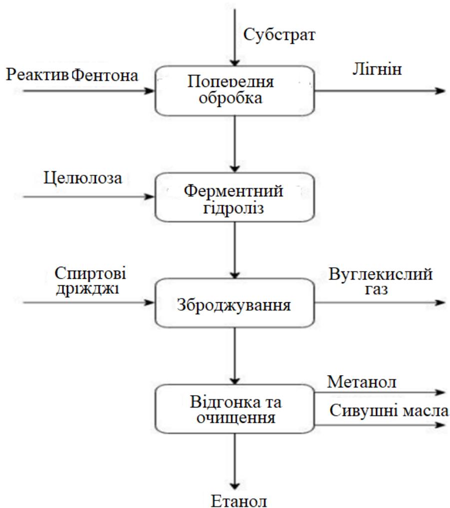
Принципова схема виробництва технічного етилового спирту із лігноцелюлозного субстрату [8].
