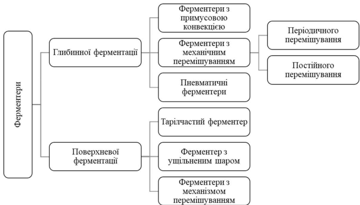
Рис. 1.7. Технологічні режими ферментації субстратів для отримання біоетанолу (технічного етилового спирту) [20].
