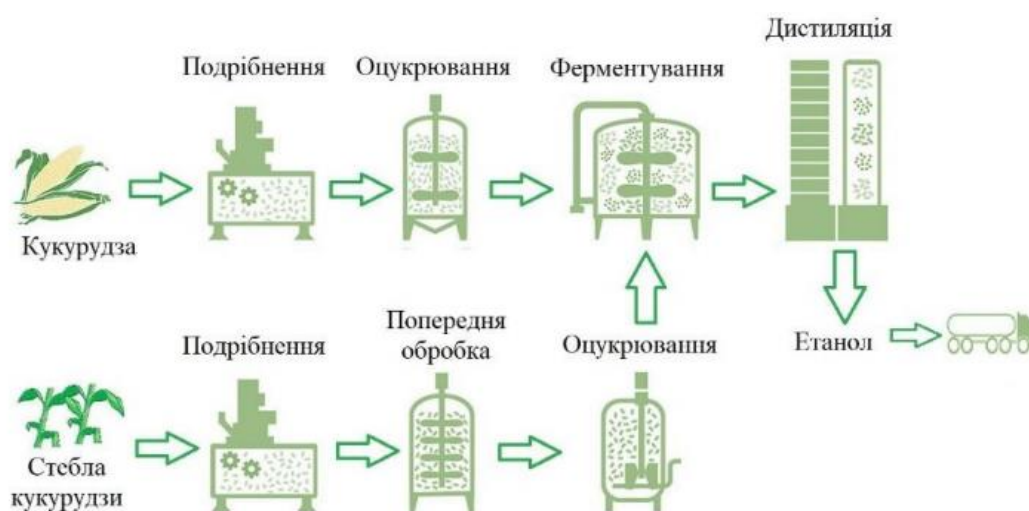
Рис. 1.6. Технологічний процес виробництва етилового спирту із кукурудзи [12].
