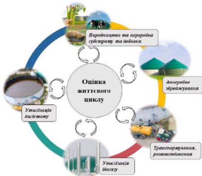
Рис. 3.8. Технологічний процес одержання та використання біогазу та дигестату за анаеробної ферментації відходів тваринницьких ферм
