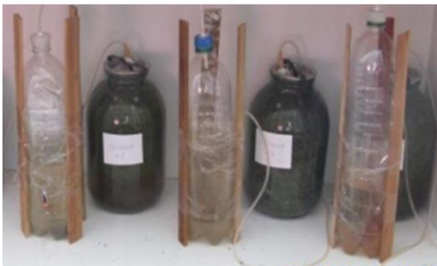
Рис. 2.3. Лабораторна установка анаеробного зброджування
