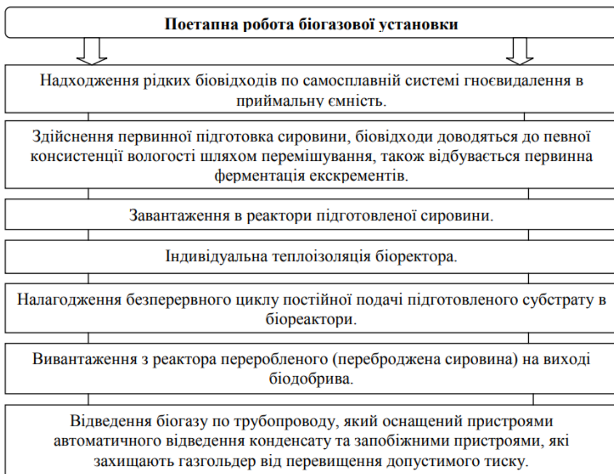
Рис.1.4. Типовий механізм роботи біогазової установки [22].
