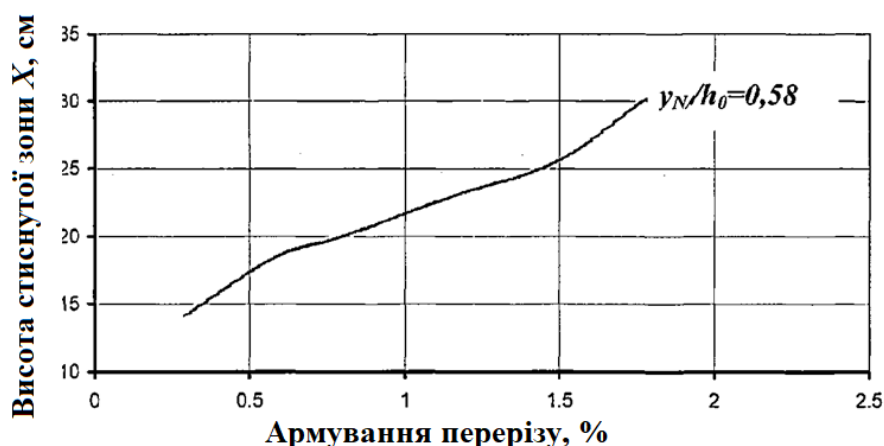
Рис. 6.8 Залежність висоти стиснутої зони перерізу стику від армування розтягнутої зони
