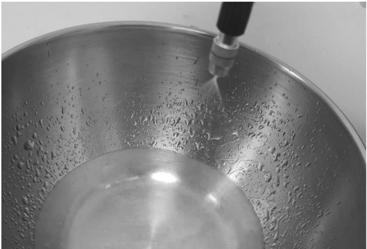
Рисунок 3.6 – Проведення дослідів із пропусканням дистильованої води через очищену форсунку за сталого тиску в системі.
