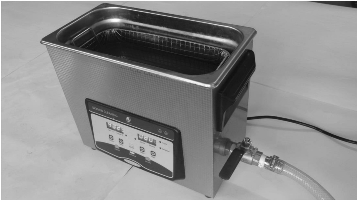
Рис. 3.1. – Ультразвукова ванна моделі Ultrasonic Cleaner JP-031S.
