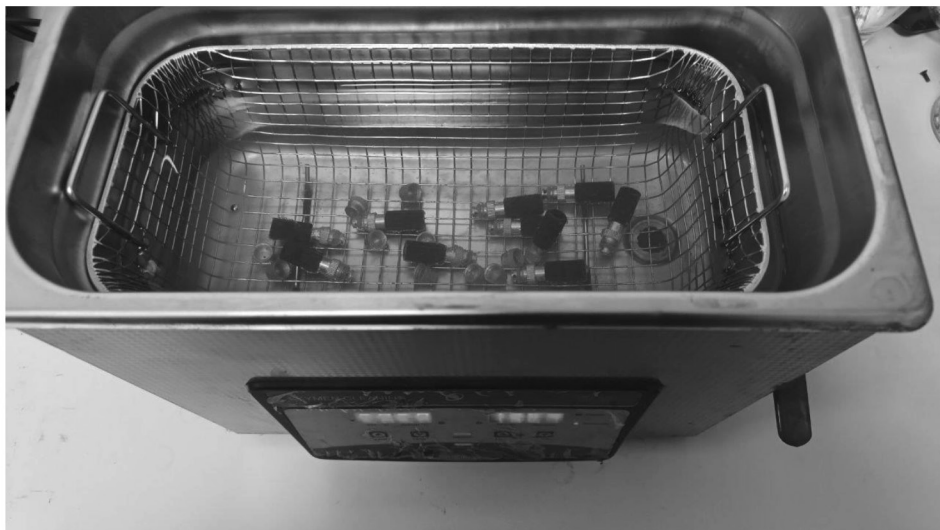
Рисунок 3.4. – Налаштування ультразвукової ванни.
