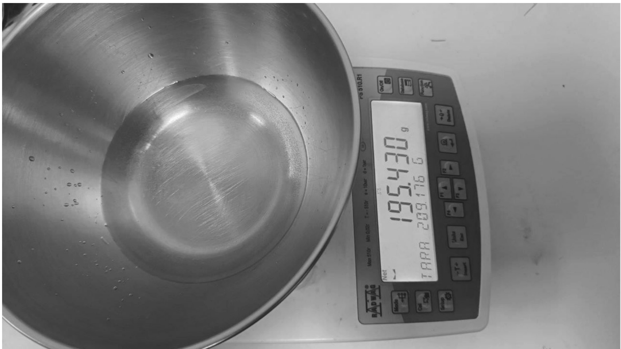
Рисунок 3.7 (а, б) – Зважування зібраної дистильованої води.
