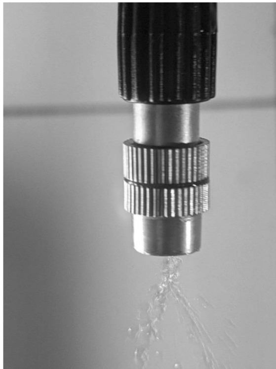
Рисунок 3.8 – (а, б,) приклад розпилювання води через засмічену форсунку.
