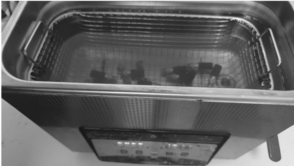
Рисунок 3.5. (а, б) – Процес миття форсунок.
