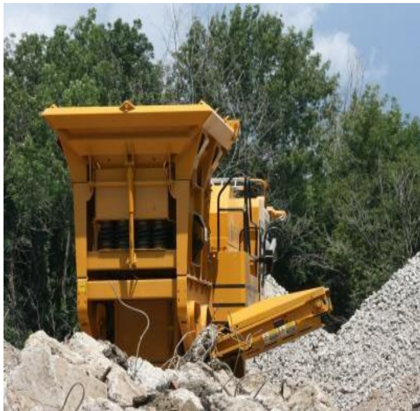
Рисунок 3.3 – Стаціонарний дробильно-сортувальний комплекс для переробки будівельних відходів
