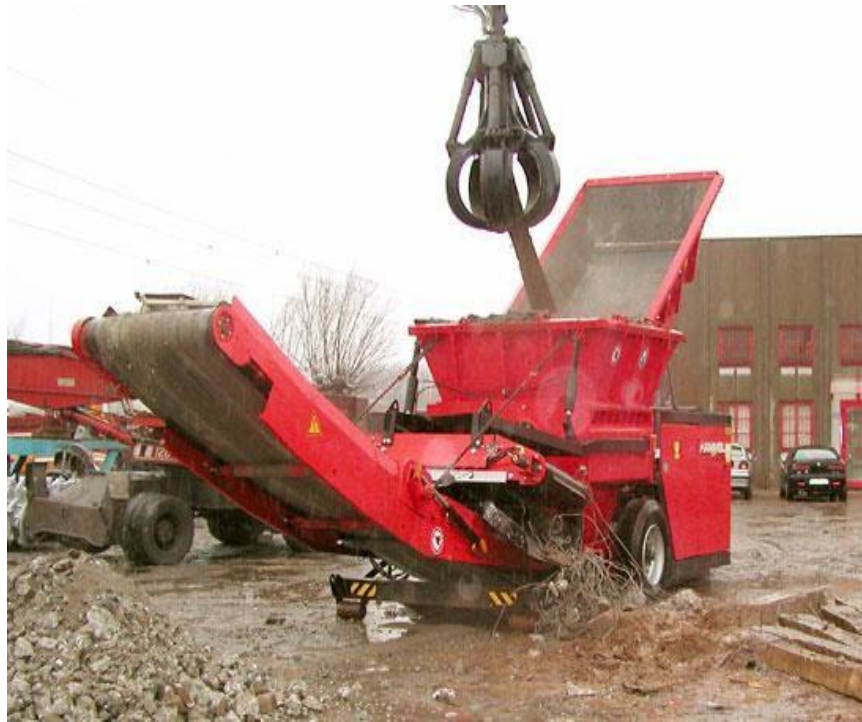
Рисунок 3.4 – Мобільний дробильно-сортувальний комплекс для переробки будівельних відходів
