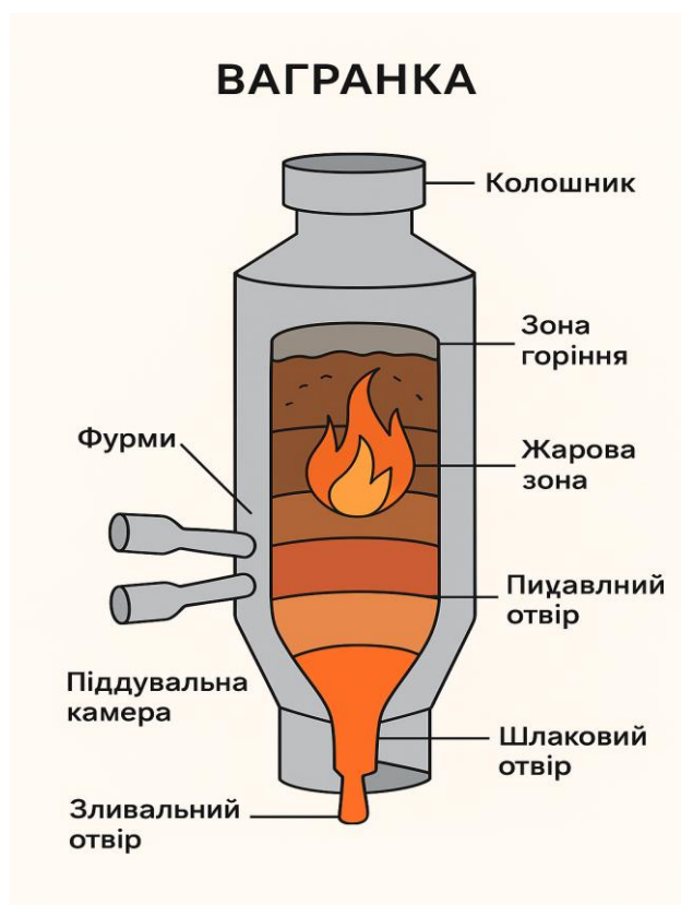
Рисунок 3.1 – Основні частини вагранки
