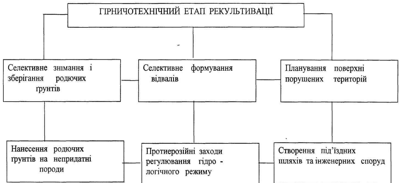
Рис. 2. Гірничотехнічний етап рекультивації.
