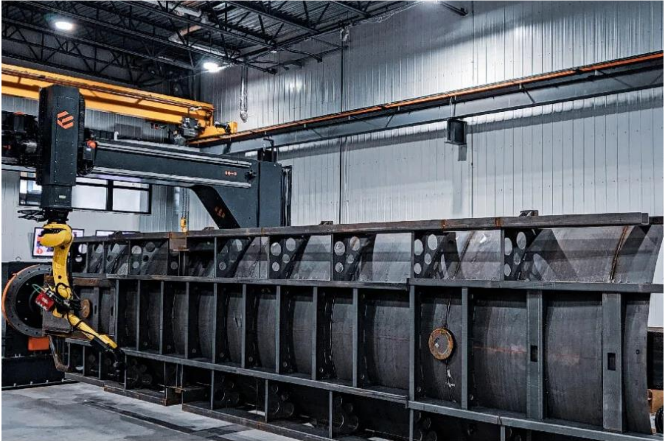
Рисунок 1.2 Роботизований зварювальний комплекс з додатковими 2-ма осями
