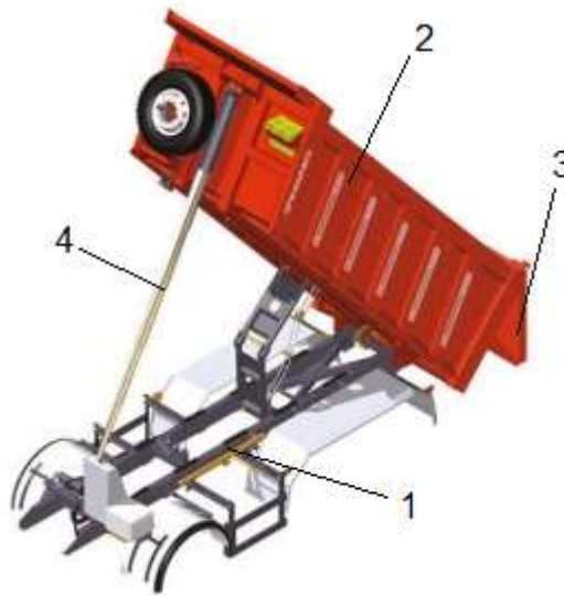
Рисунок 1.3 – Конструкція вантажної платформи самоскида
