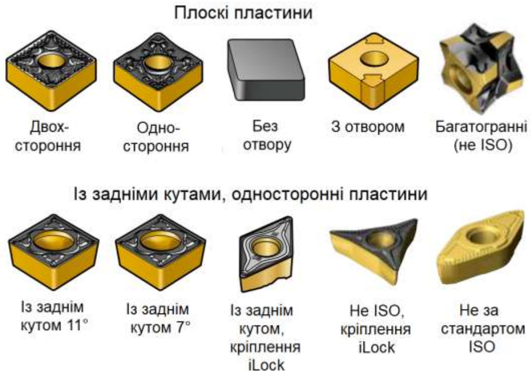
Рисунок 3.4 – Основні типи ріжучих пластин токарних різців
