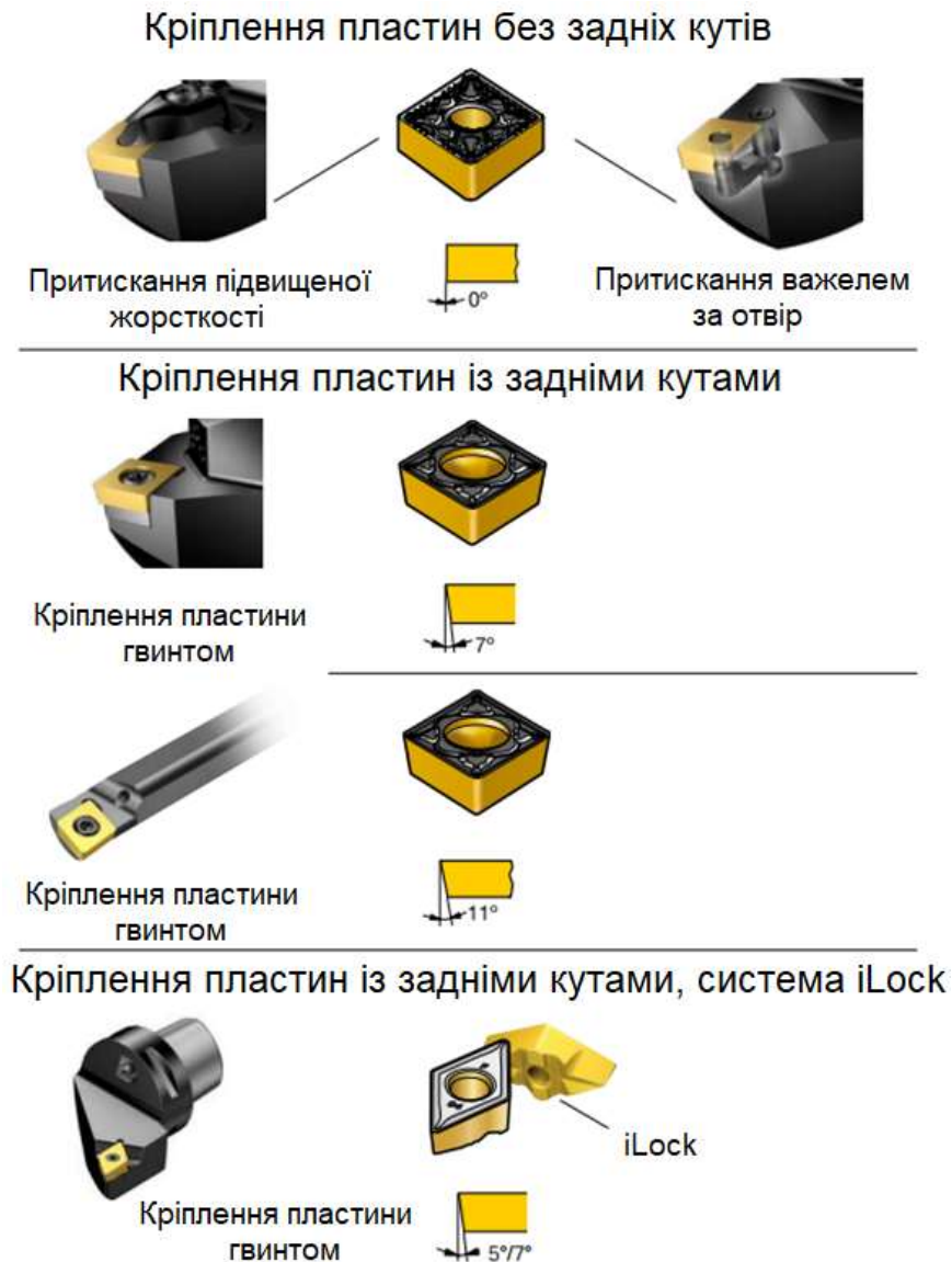
Рисунок 3.3 – Способи кріплення пластин до державок
