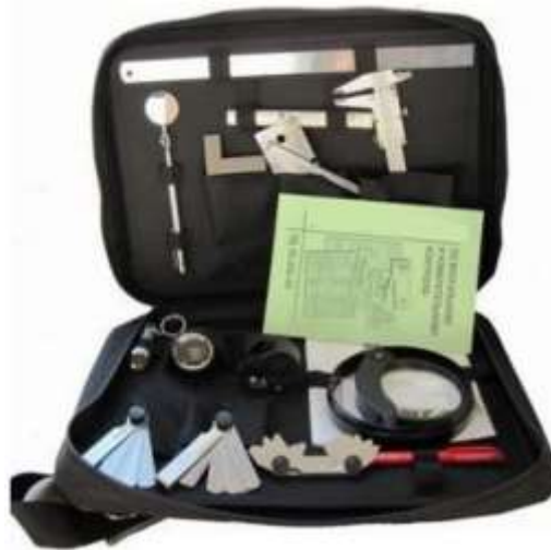
Рисунок 1.8 – Устаткування для проведення візуально-вимірювального контролю
