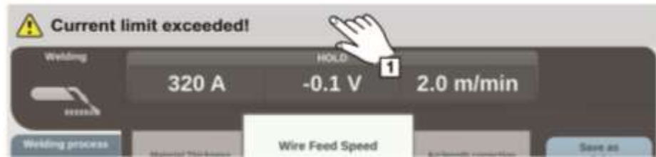
Рисунок 4.9 – Рядок стану - досягнутий ліміт струму
