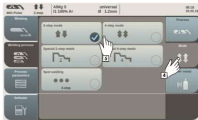
Рисунок 4.11 – Послідовність вибору режиму зварювання
