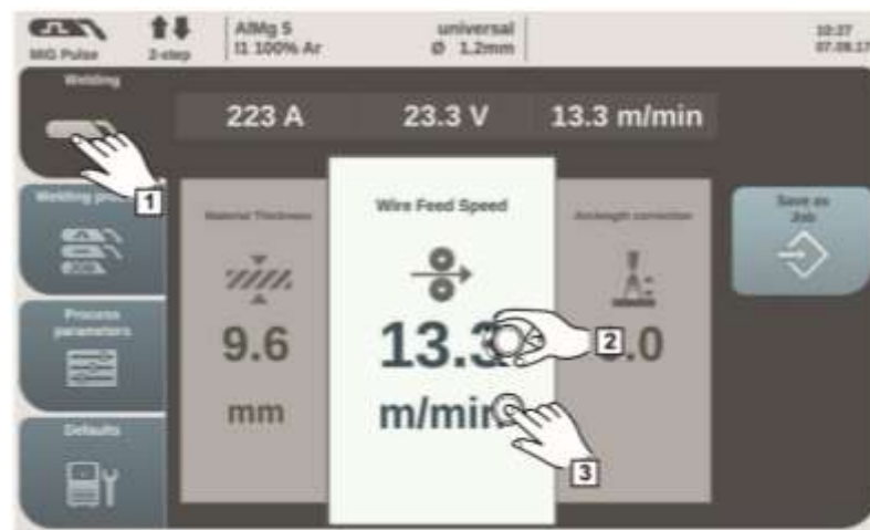
Рисунок 4.13 – Послідовність налаштування параметрів процесу зварювання
