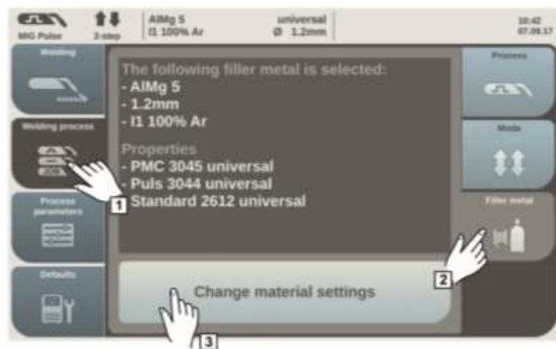
Рисунок 4.12 – Послідовність вибору присадкового матеріалу (зварювального дроту) і захисного газу
