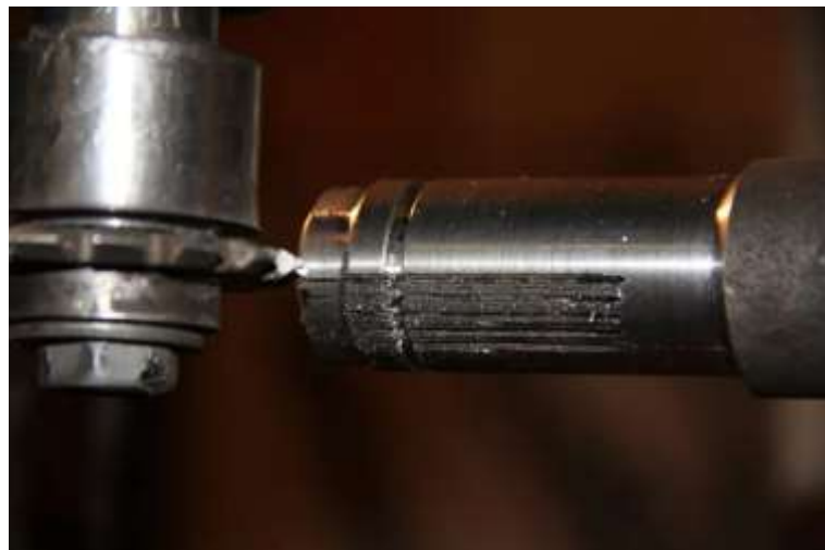
Рисунок 1.4 – Нарізання шліців спеціальними шліцевими фрезами
