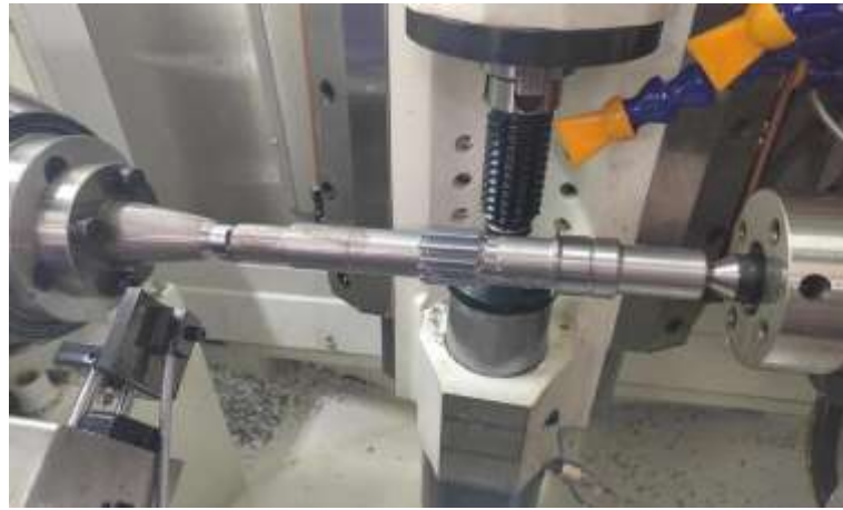
Рисунок 1.3 – Нарізання шліців багатозахідними черв'ячними фрезами
