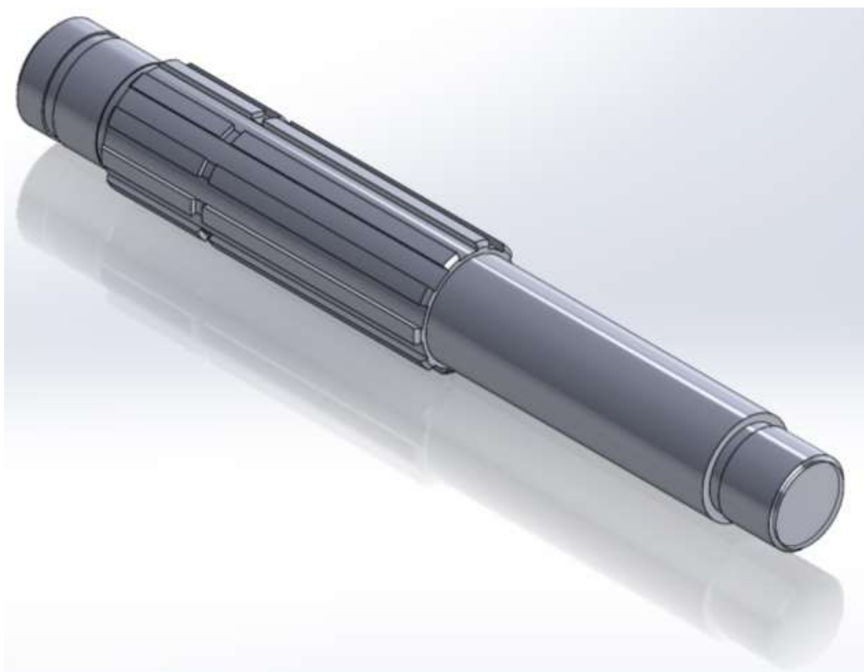
Рисунок 1.1 - 3D-модель деталі «Вал шліцевий»
