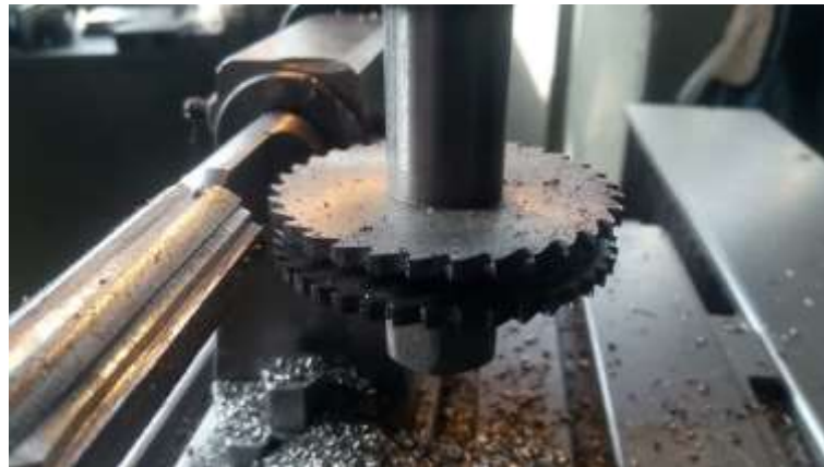
Рисунок 1.5 – Нарізання шліців фасонними дисковими фрезами
