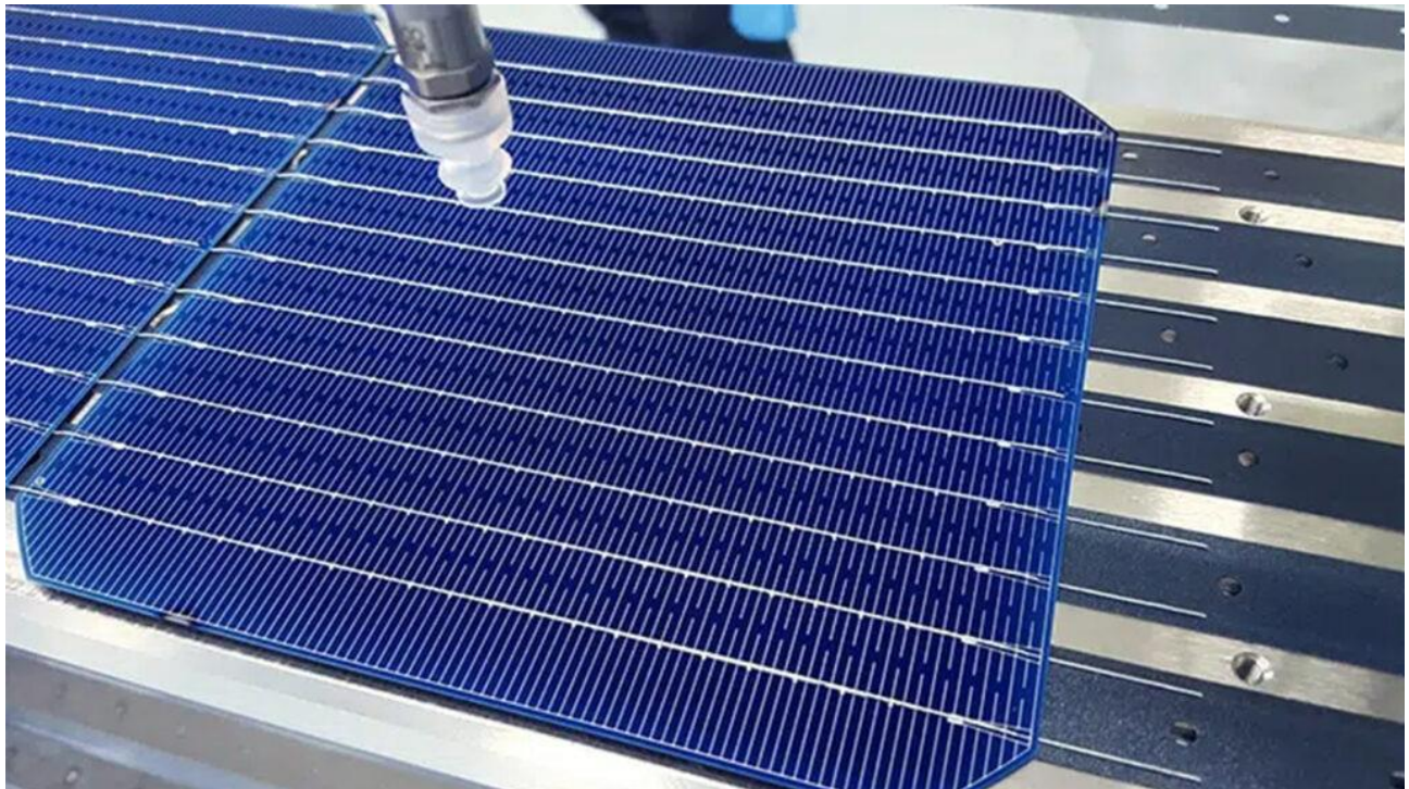
Рисунок 2.5 - Зовнішній вигляд фотоелектричної комірки з технологіями Half-cut та Multi-Busbar (MBB)
