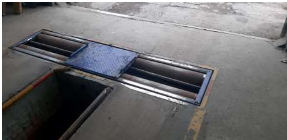
Рисунок 3.5 - Випробування автомобіля Tatra T 815 на гальмівному стенді Maha roller brake tester
