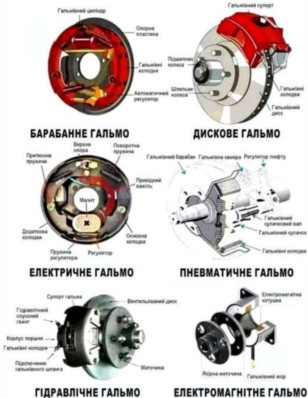
Рисунок 1.4 - Виконавчі механізми гальмівних систем
