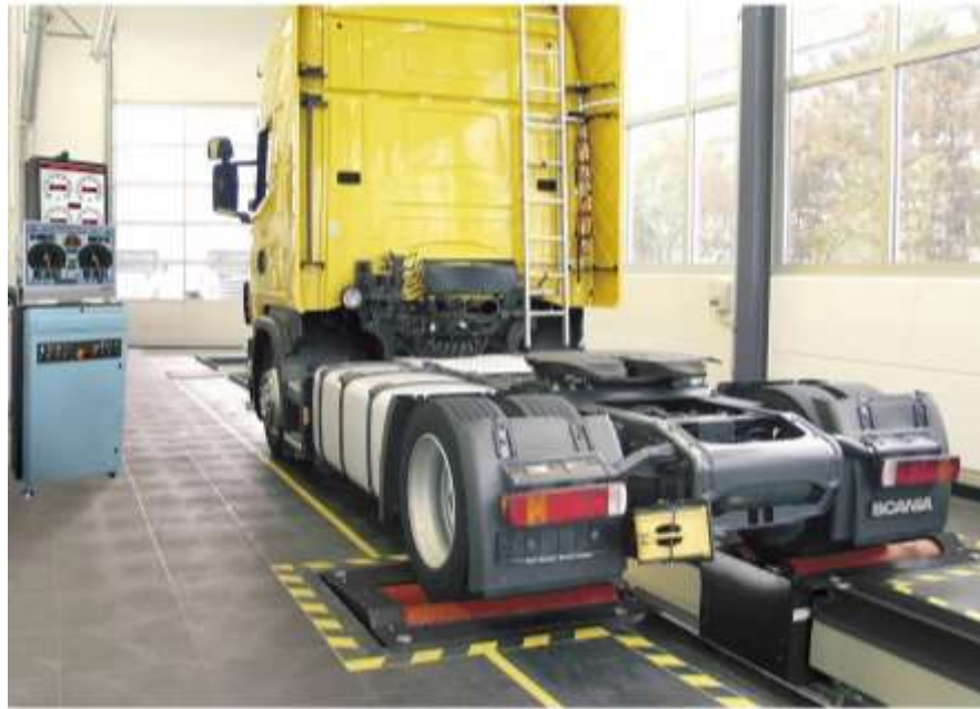
Рисунок 1.8 – Визначення питомої гальмівної сили \mu_t на роликовому стенді
