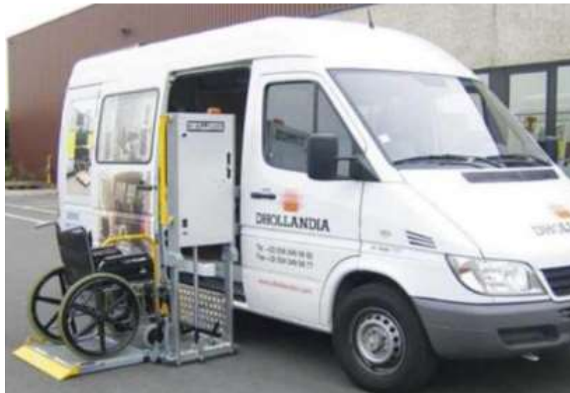
Рисунок 2.2 - Підйомний пристрій, встановлений на мікроавтобусі
