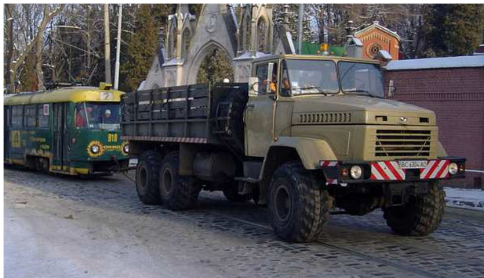
Рисунок 3.1 – Буксирування трамвая на жорсткому зчепленні
