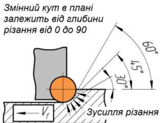
Рисунок 3.8 - Фрези із круглими пластинами
