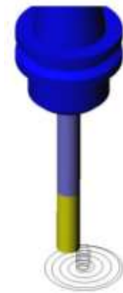
Рисунок 3.13 - Траєкторія спірального врізання з виходом у площину обробки
