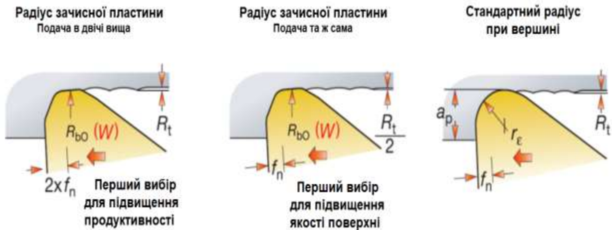
Рисунок 4.12 - Зачисні пластини Wiper
