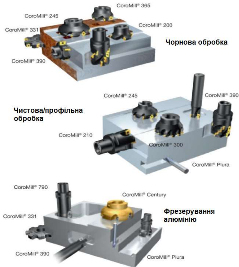
Рисунок 4.14 - Основні види фрезерування та різальний інструмент
