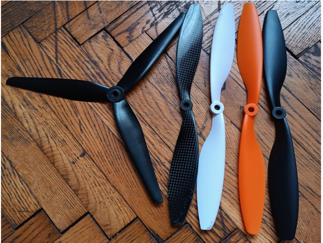
Рисунок 3.2 - Пропелери трьохлопасні 1045, двохлопасні пластикові 1045 та двохлопасні карбонові 1047.
