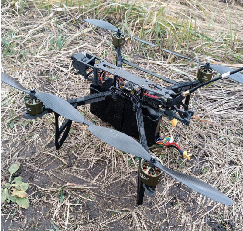
Рисунок 2.6 - Розташування акумуляторної батареї 6S3P внизу дрона.
