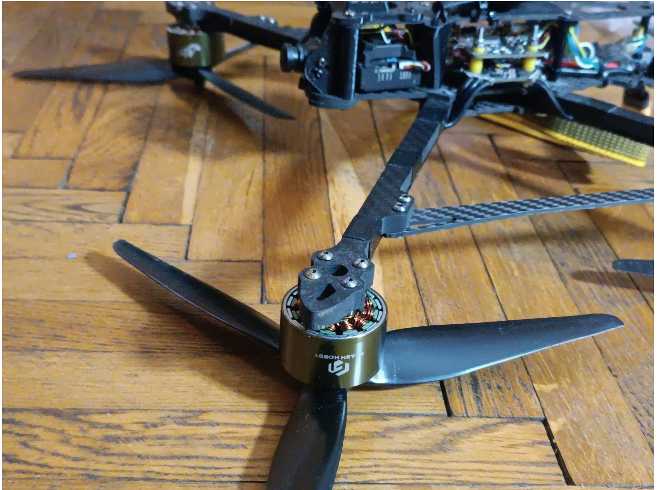
Рисунок 3.5 - FPV-дрон у конфігурації "Pusher"
