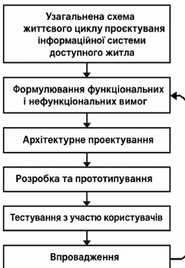
Рисунок 1.5 – Узагальнена схема життєвого циклу проєктування інформаційної системи доступного житла
