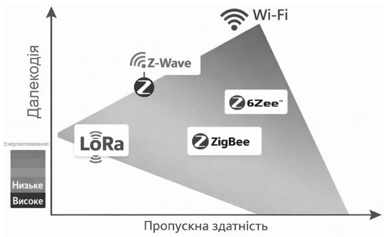
Рисунок 1.3 – Схематична залежність між пропускнуою здатністю, радіусом дії та енергоспоживанням для типових бездротових технологій «розумного будинку»
