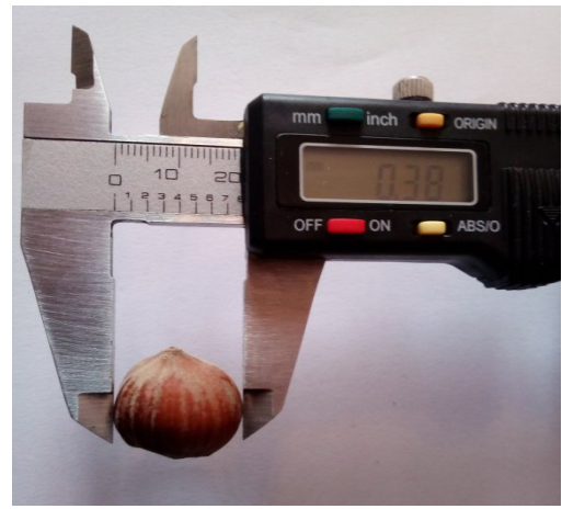
Рисунок 3.3- Обладнання для замірів розмірних показників лісових горіхів
