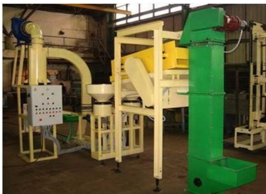
Рисунок 1.7 - Лінія для лушення горіхів Ш24-ШОЖ1.1.00 виробництва ВПКТІ
