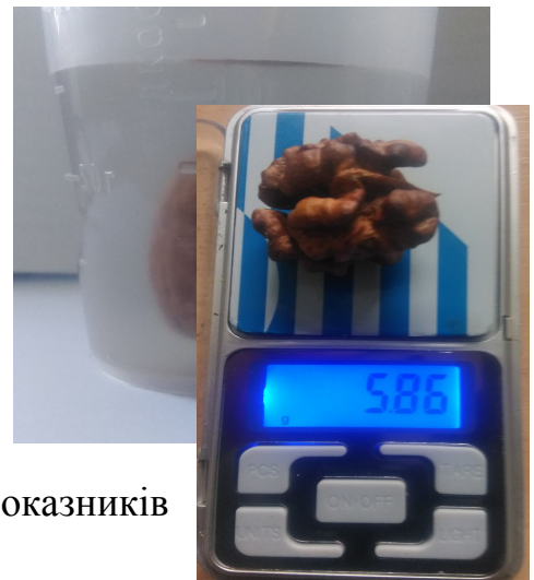
Рисунок 3.1- Обладнання для замірів розмірних і масових показників горіха і ядра
