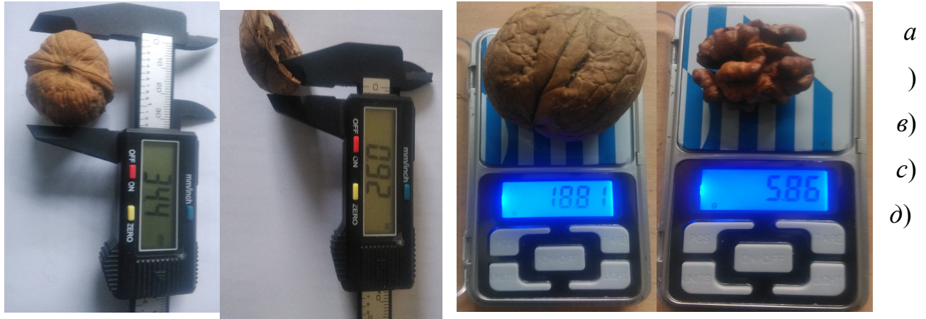
Рисунок 3.1- Обладнання для замірів розмірних і масових показників горіха і ядра
