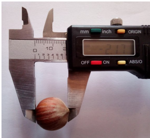
Рисунок 3.3- Обладнання для замірів розмірних показників лісових горіхів
