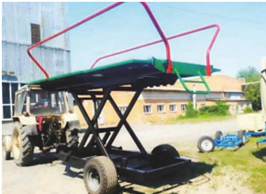
Рисунок 1.7 – Причіпна плодозбиральна платформа ТДВ «Брацлав»
