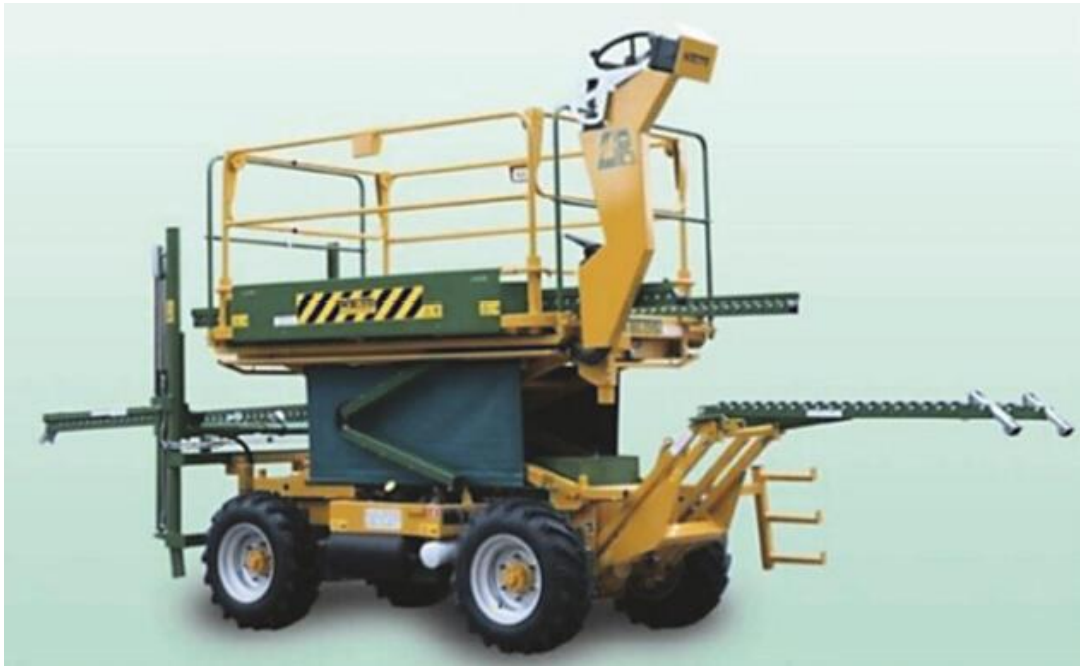
Рисунок 1.6 - Самохідна плодозбиральна платформа Zip 30
