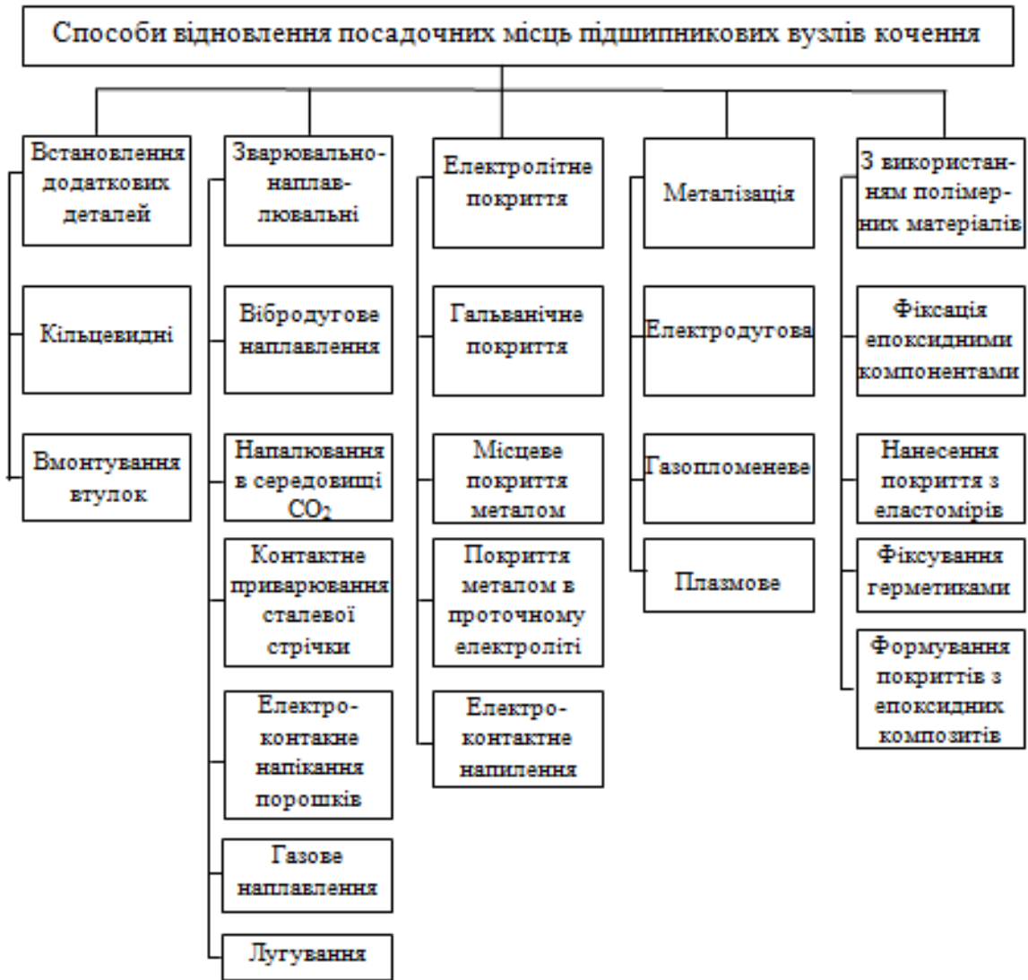
Рисунок 1.3 – Класифікація способів відновлення посадочних місць підшипниковий вузол кочення
