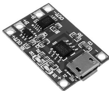
Рисунок 2.15 – Зарядний модуль TP4056 для літієвого акумулятора системи
