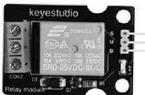
Рисунок 2.14 – Релейний модуль для підключення периферійного обладнання
