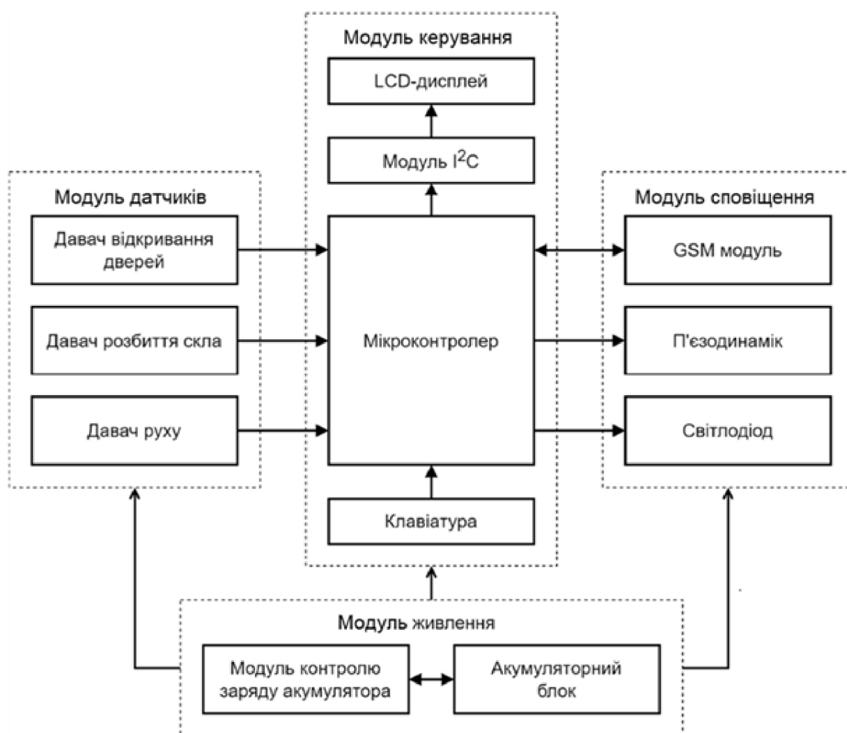
Рисунок 2.2 – Деталізована структурна схема модулів системи охоронної сигналізації
