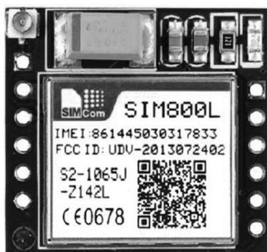
Рисунок 2.11 – GSM-модуль SimCom SIM800L
