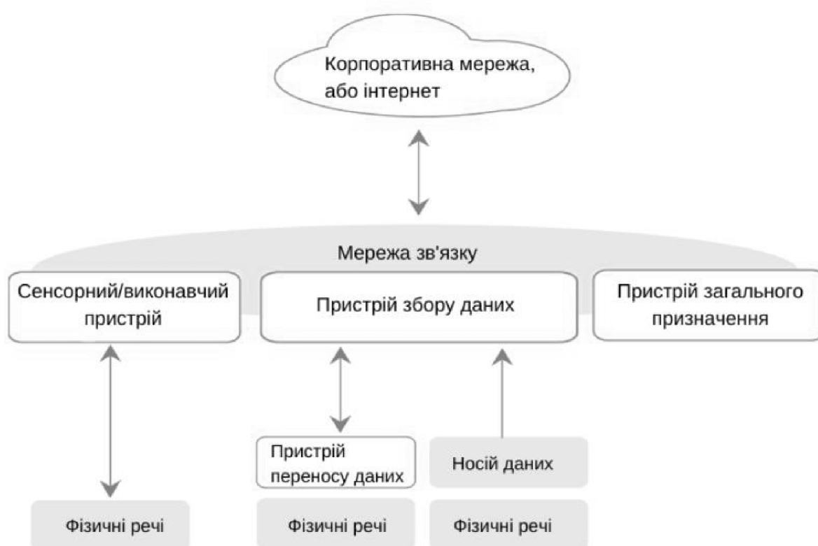
Рисунок 1.3 – Взаємодія різних типів IoT-пристроїв з фізичними об'єктами
