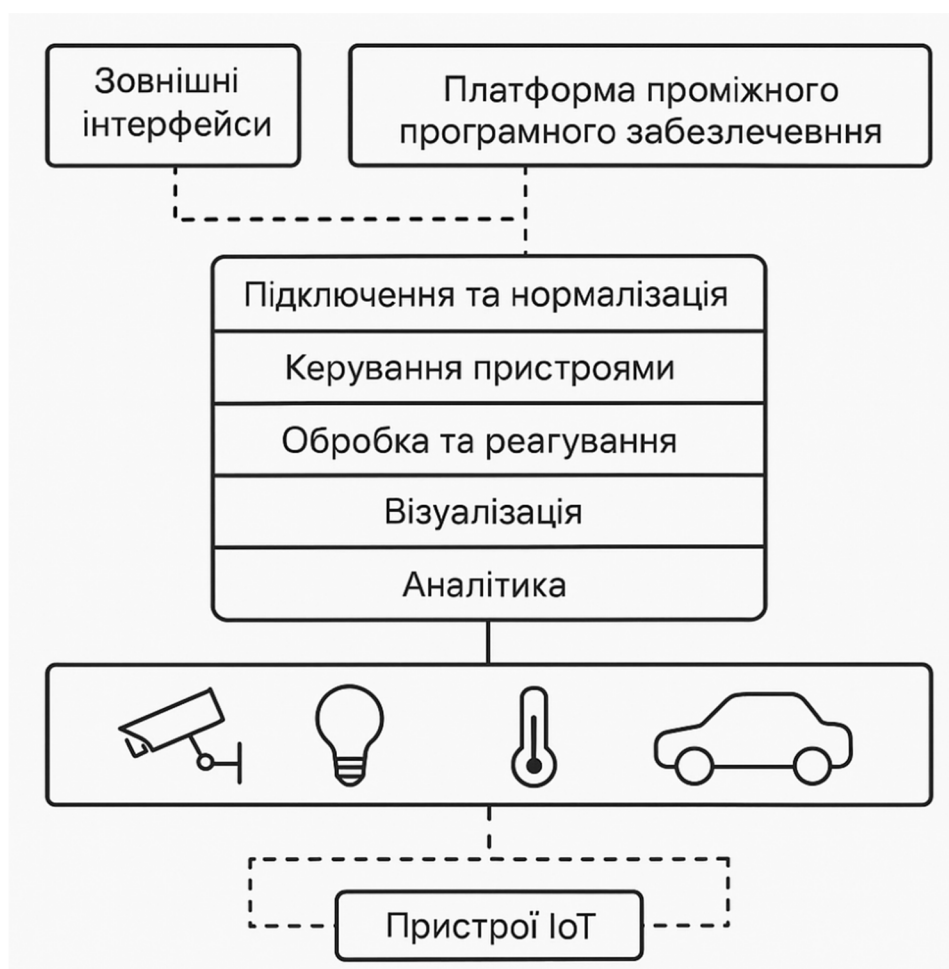
Рисунок 1.6 – Архітектура IoT на основі платформ проміжного програмного забезпечення
