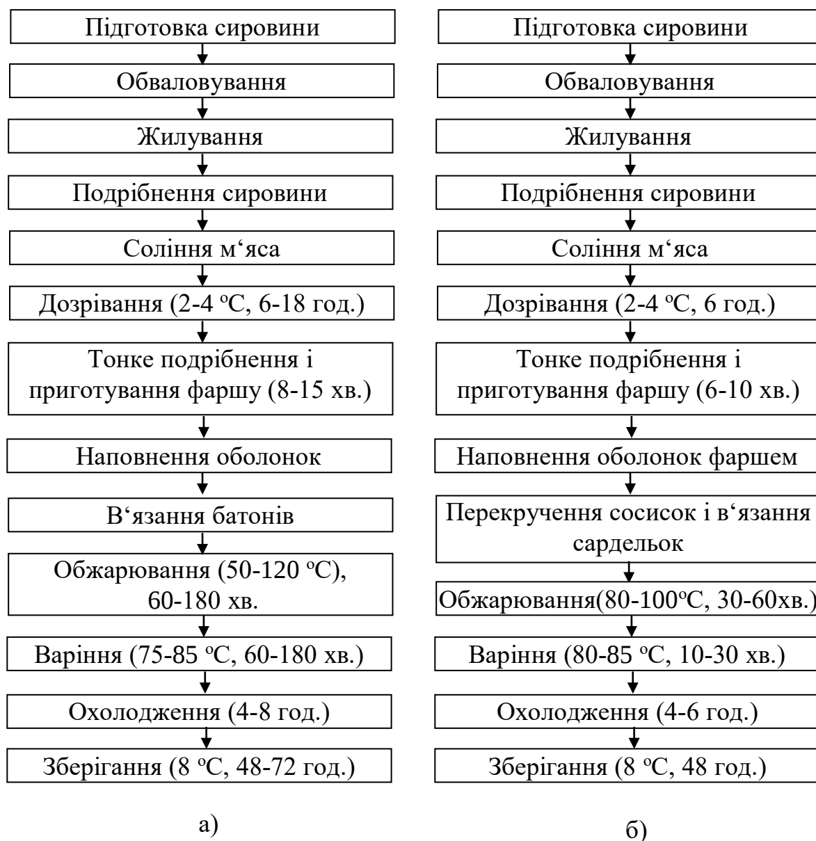
Рисунок 1.1 - Технологічні схеми виготовлення ковбасних виробів:
