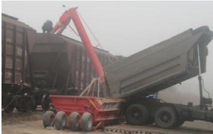
Рисунок 1.2 – Бункер перевантажувач БНП- 12/Е (електричний) ТОВ «Завод Кобзаренка»
