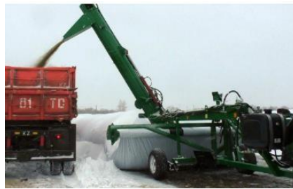
Рисунок 1.3 – Гвинтовий перевантажувач з приводом від трактора фірми «Ліліан МВА»
