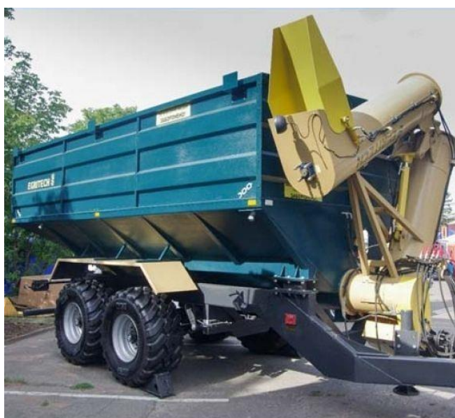
Рисунок 1.9 – Бункер- накопичувач ПБН-16 ТОВ «Завод Кобзаренка»
