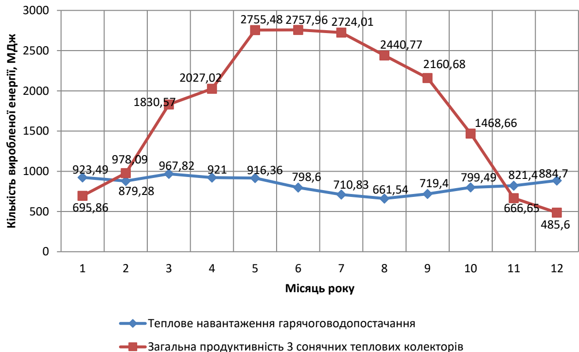
Рисунок 3.2 – Енергетичний баланс роботи сонячної теплової системи гарячого водопостачання
