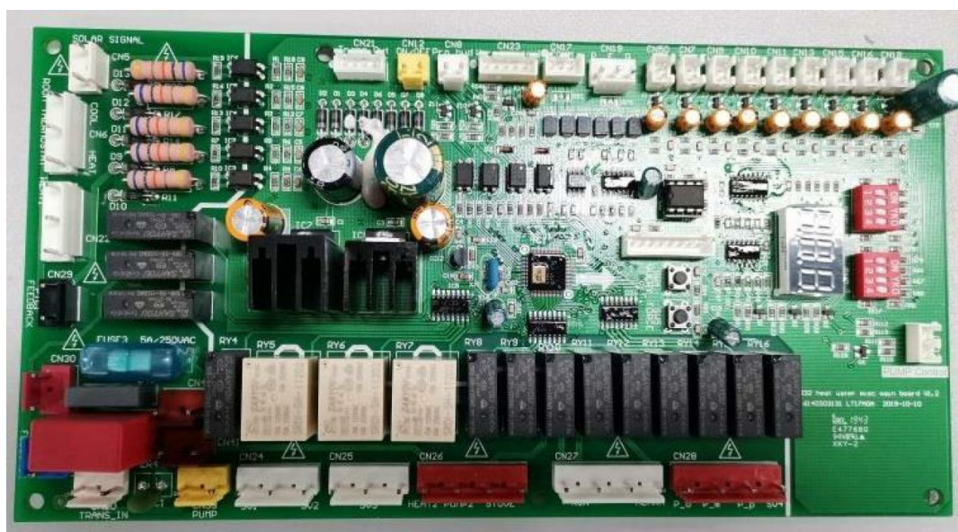
Рисунок 3.7 – Загальний вигляд модуля розширення плати універсального мікропроцесорного модуля
