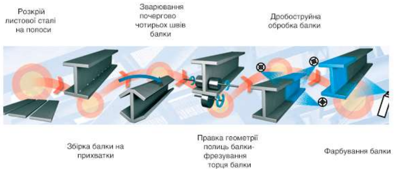
Рисунок 1.1 – Схема процесу виготовлення зварної балки
