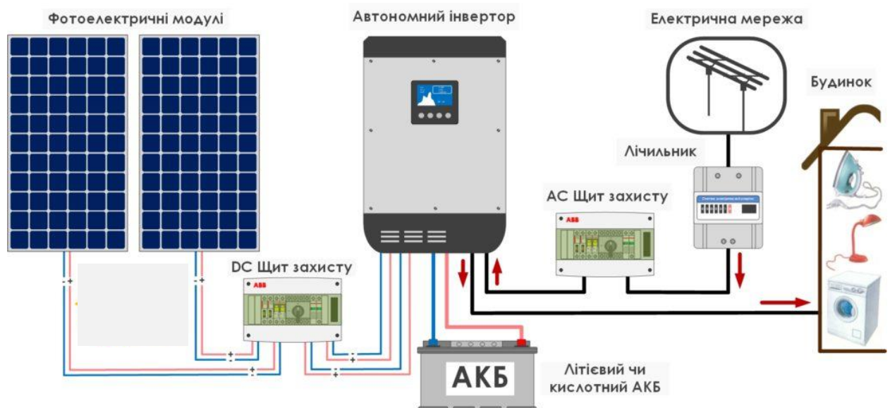
Рисунок 3.2 – Схема фотоелектричної установки живлення досліджуваного об'єкта
