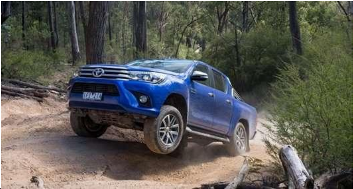
Рисунок 2.1 – Приклад діагонального вивішування автомобіля
