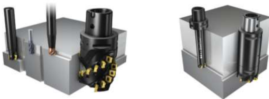
Рисунок 3.4 – Схема обробки виступів фрезеруванням
